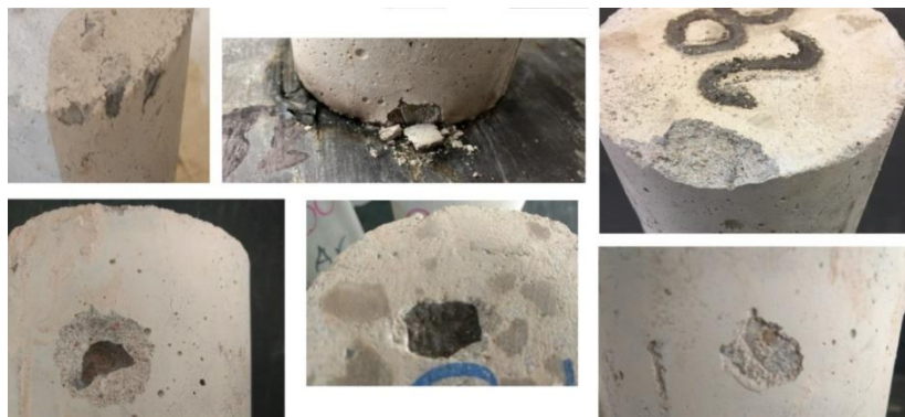
Figura 25 - Exemplos da degradação sofrida por alguns CPs dentro no mesmo lote ensaiado
