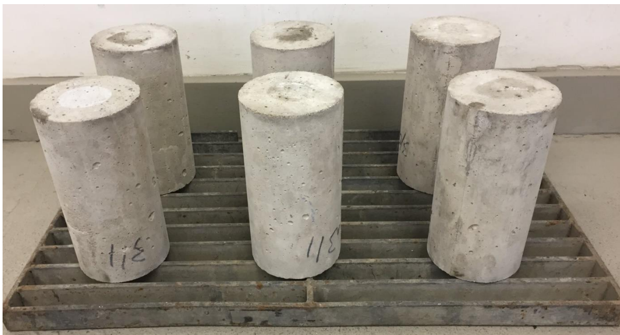
Figura 22 - CPs resfriados com água aguardando equalização com temperatura ambiente
