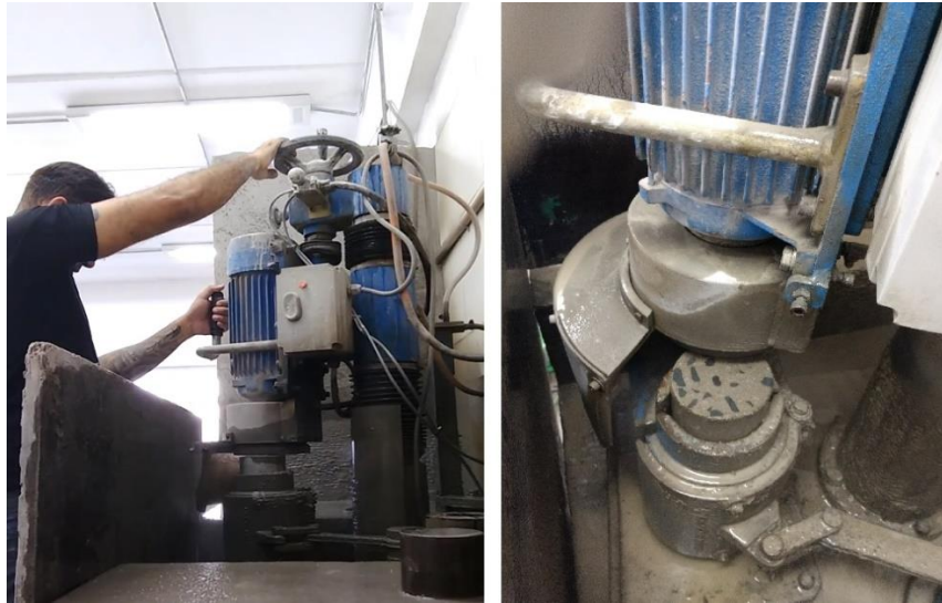
Figura 16 – Processo de retificação dos CPs
