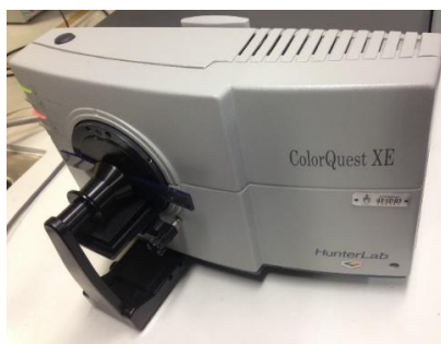
Figura 9: Espectrofotômetro ColorQuest XE da HunterLab com o suporte para a amostra.
