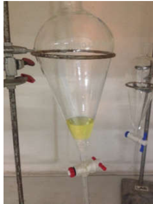
Figura 4.4: Ilustração da lavagem nos funis de separação.
