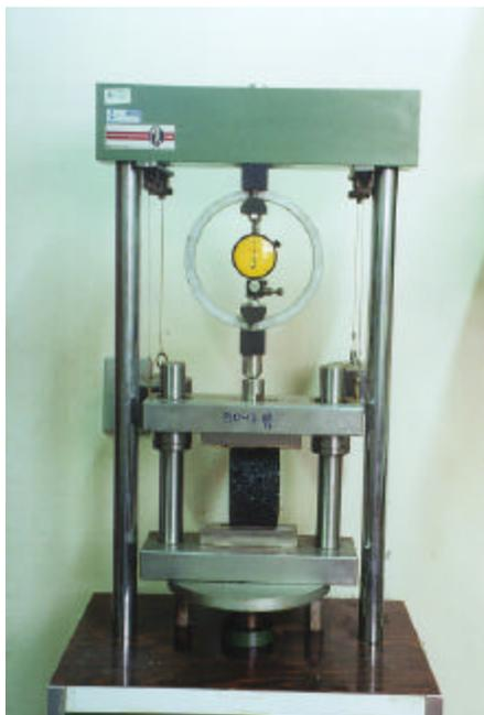
FIGURA 3.7. Vista do equipamento de compressão diametral
