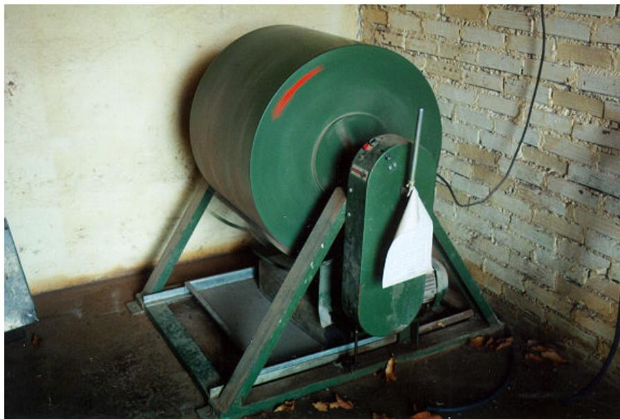
FIGURA 3.3. Execução de ensaio de desgaste Cantabro no equipamento *Los Angeles*.
