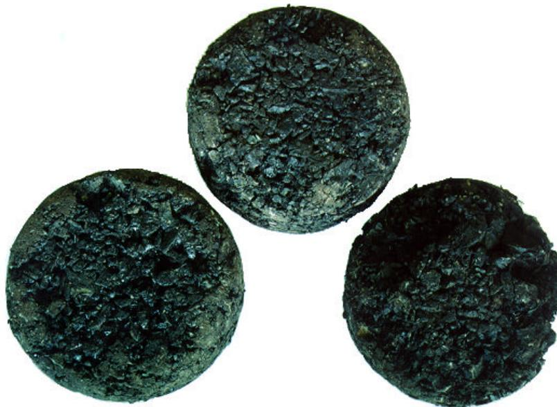
FIGURA 3.4. Aspecto dos corpos de prova após o ensaio de desgaste Cantabro.
