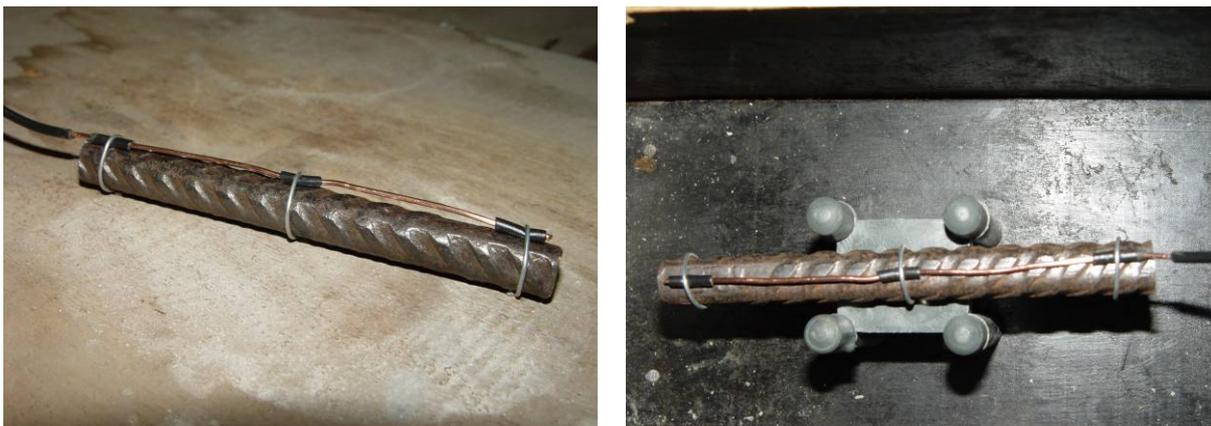
Figura 4.15 – Posicionamento do fio de cobre nos cps de calibração.
