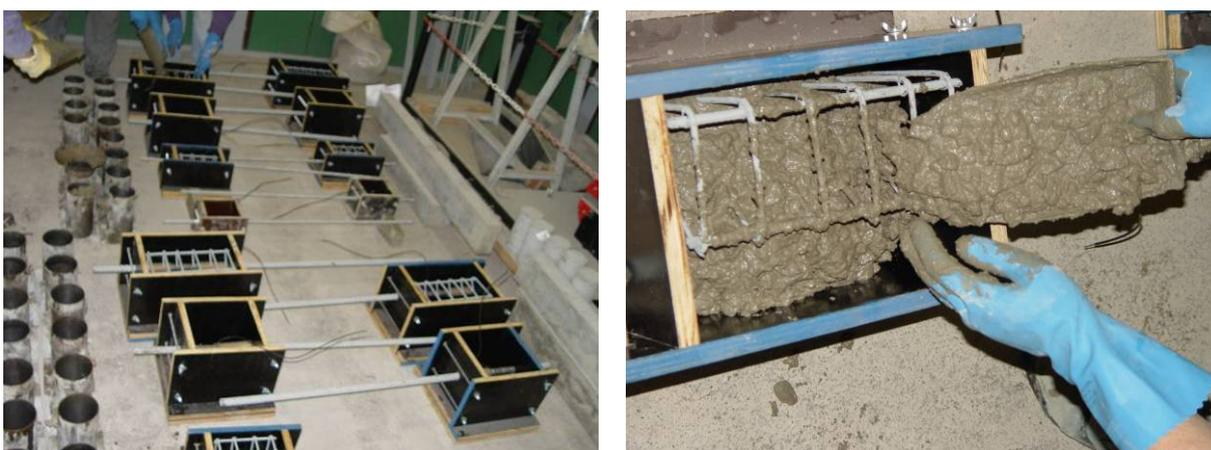
Figura 4.8 – Vista da concretagem dos corpos de prova de aderência e de controle de resistência do concreto.
