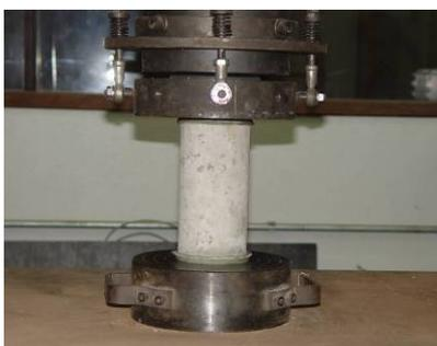
Figura 4.9 – Ruptura dos corpos-de-prova de controle.
