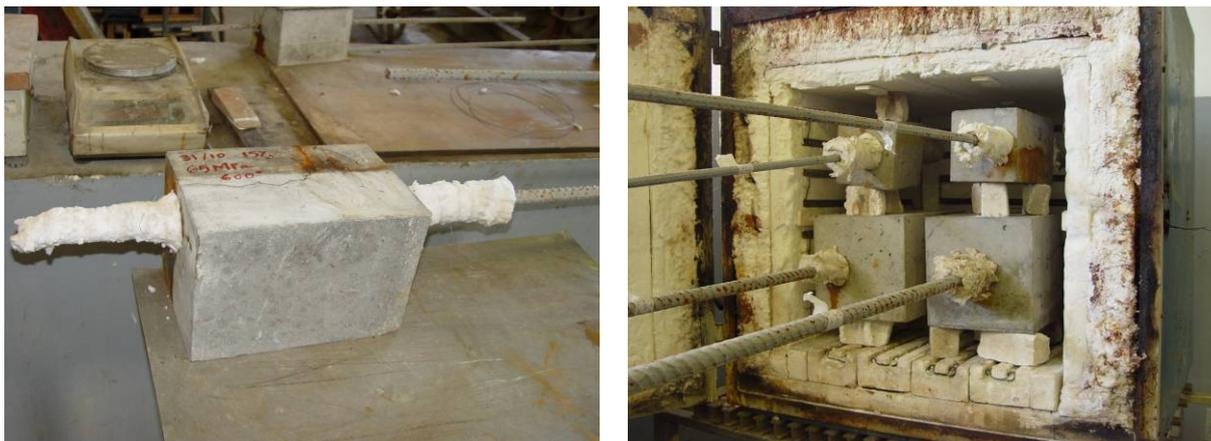
Figura 4.22 – Revestimento da barra e disposição dos cps no forno.
