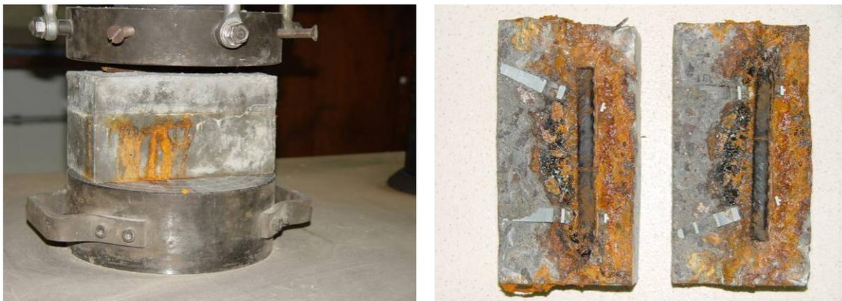
Figura 4.17 – Processo de extração da barra de armadura dos cps de calibração.
