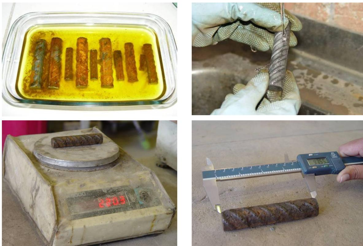
Figura 4.19 – Procedimento para determinação do percentual de perda de massa das barras corroídas e submetidas ao ensaio de aderência.
