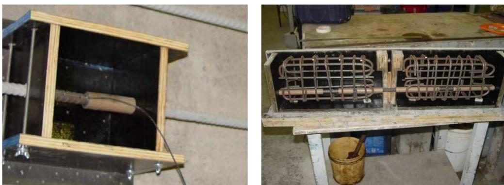
Figura 4.7 – Detalhe de corpos-de-prova de arrancamento simples e de viga, preparados para a concretagem.
