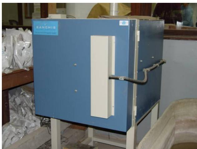
Figura 4.20 – Vista do forno elétrico utilizado para o aquecimento dos corpos-de-prova.
