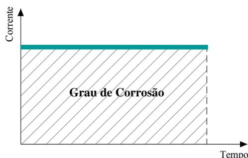
Figura 5.2 – Determinação do grau de corrosão pela Lei de Faraday.
