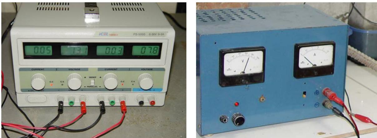
Figura 4.12 – Fontes de alimentação utilizadas para aceleração da corrosão.
