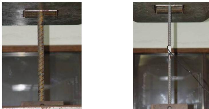
Figura 4.3 – Realização dos ensaios de tração nas barras de aço.
