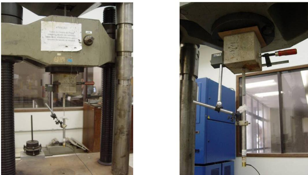
Figura 4.27 – Detalhe do ensaio de arrancamento simples.
