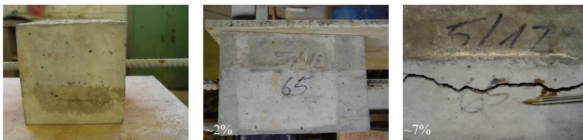
Figura 5.16 – Detalhe de diferentes aberturas de fissuras.
