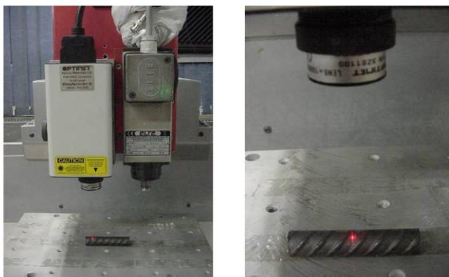
Figura 5.27 – Detalhe do escaneamento do segmento de barra.
