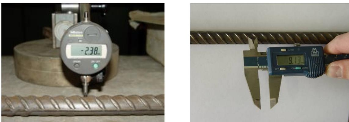
Figura 5.29 – Detalhe da leitura da altura da nervura e do espaçamento entre elas (eixo a eixo).
