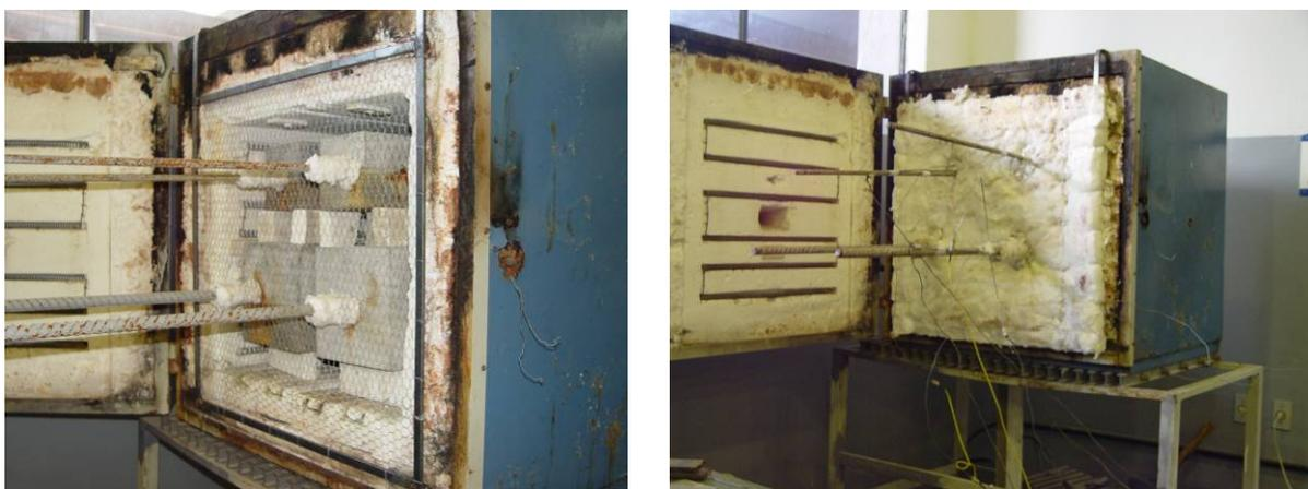
Figura 4.21 – Detalhe da porta para fechamento do forno elétrico.
