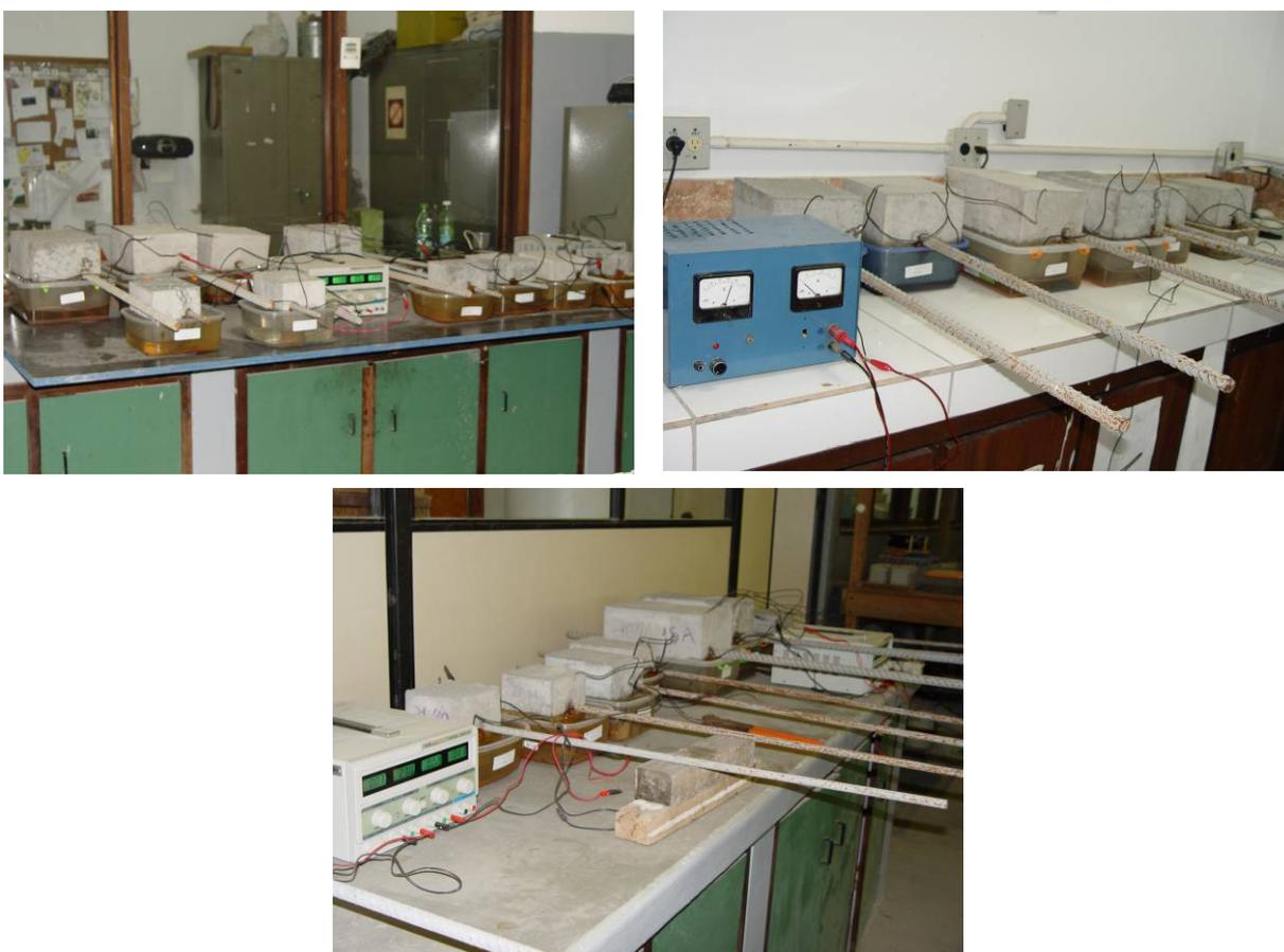
Figura 4.14 – Disposição dos corpos-de-prova de arrancamento submetidos à indução do processo corrosivo.
