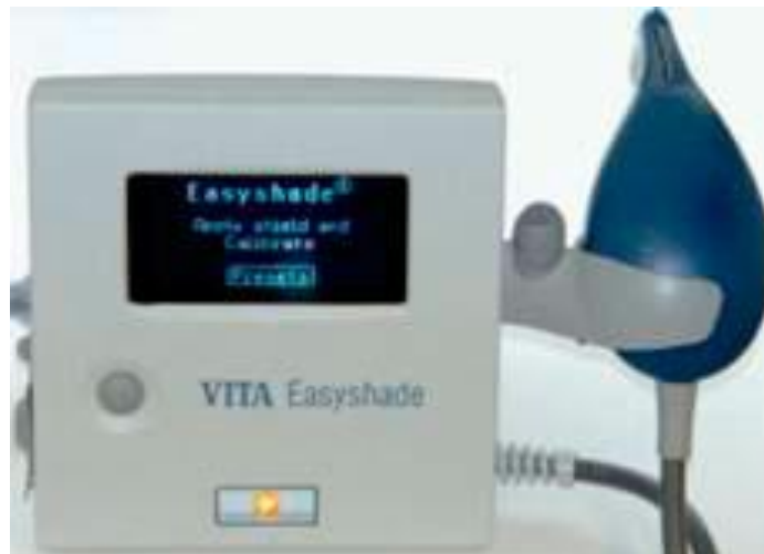
Figura 2 – Espectrofotômetro Vita Easyshade/Vita utilizado para análise quantitativa de cor
