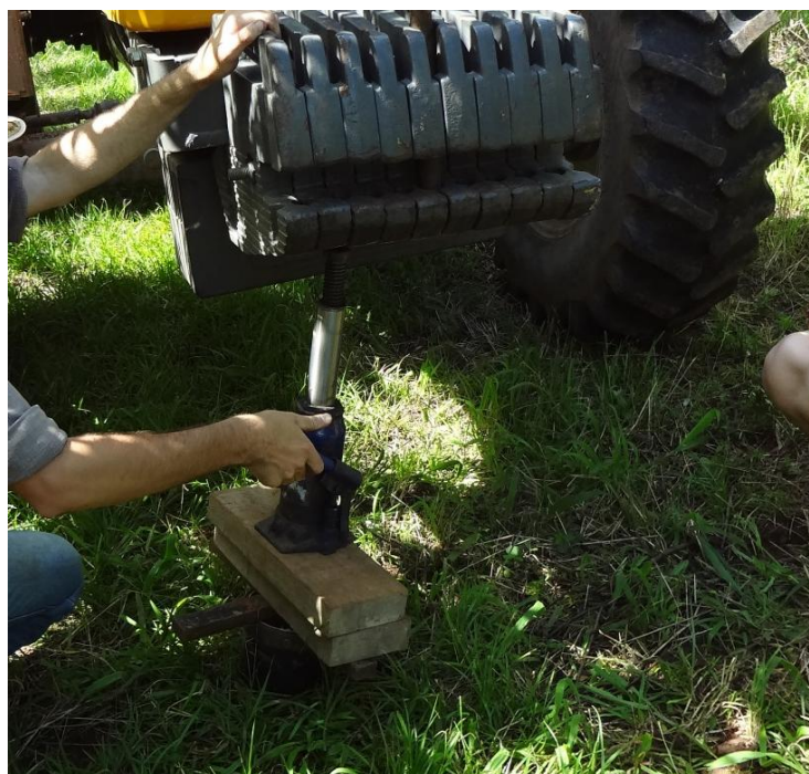
FIGURA 4. Utilização de um macaco hidráulico apoiado ao lastro dianteiro do trator para penetração da sonda no solo. EEA-UFRGS, Eldorado do Sul, 2013.
