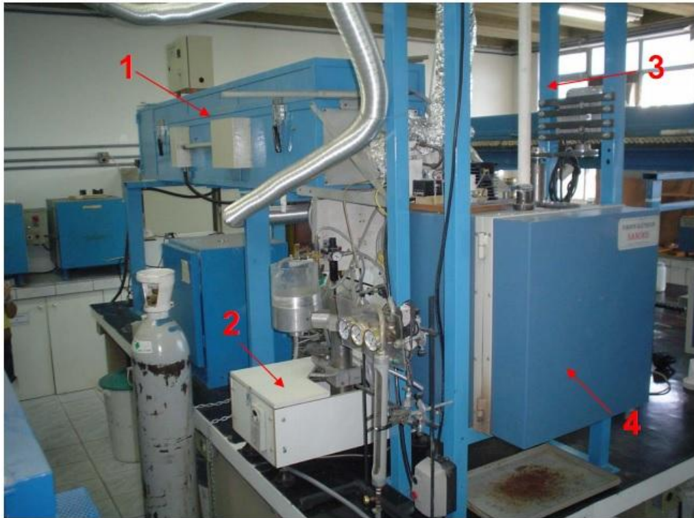
Figura 4.5 Equipamento para ensaios de desgaste erosivo suas principais partes: 1. Sistema de pré-aquecimento do ar; 2. Sistema de alimentação de partículas erodentes; 3. Sistema venturi-acelerador de partículas; 4. Câmara/forno de ensaios [62] .
