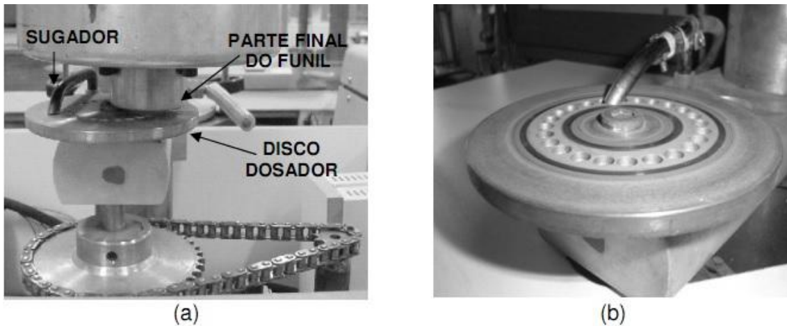
Figura 4.8 Sistema do funil alimentador de partículas, com disco dosador em detalhe e a parte final do funil. a) Conjunto do sistema alimentador. b) Detalhe do disco dosador [18] .
