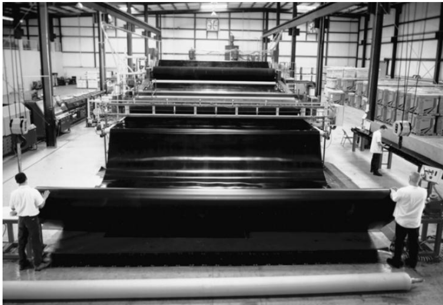
Figura 15: Produção de geomembrana – Calandras [33]
