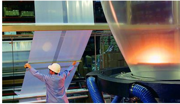
Figura 16: Produção de filmes plásticos pelo processo de extrusão sopra [45]
