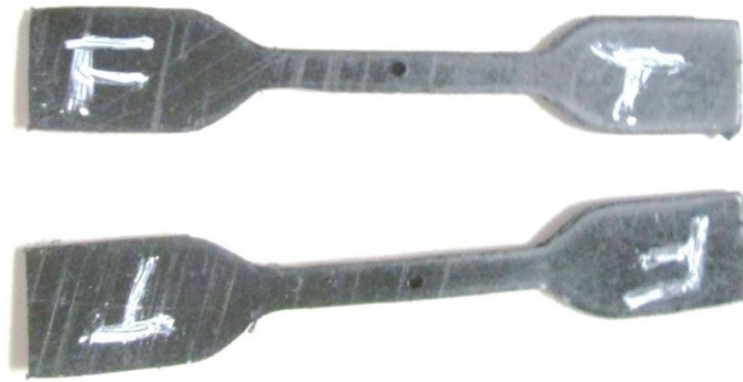
Figura 42: Amostras providas de orifício central [autor].
