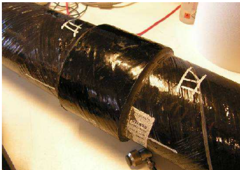
Figura 2.6 Fotografia (visão externa) de uma junta tipo luva de tubulação de ERFV [11].
