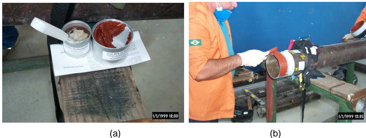
Figura 2.9 Em (a) o adesivo misturado com o agente de cura e catalisador para aplicação na junta colada; e o processo de aplicação manual do mesmo, sob a superfície usinada, em (b) [11].
