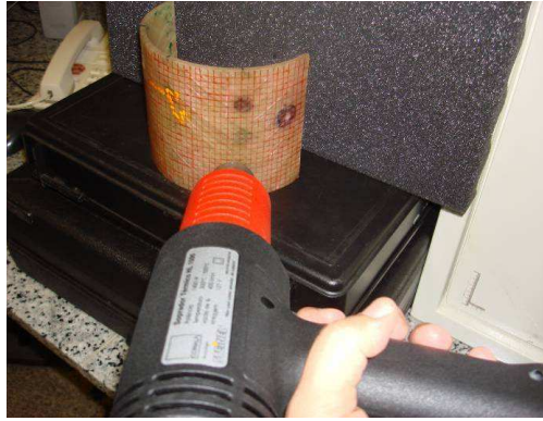
Figura 3.12 Soprador térmico em movimento de zigue-zague à distância de 20 mm do CP01.
