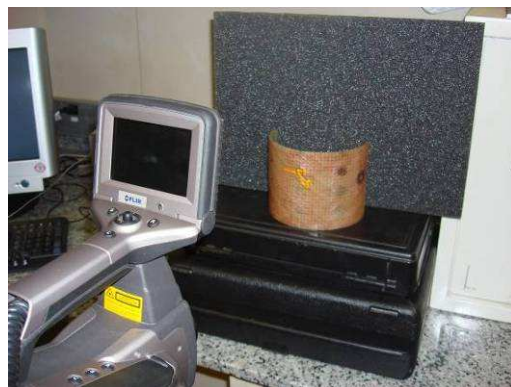
Figura 3.10 Cenário para a realização dos testes de termografia ativa.
