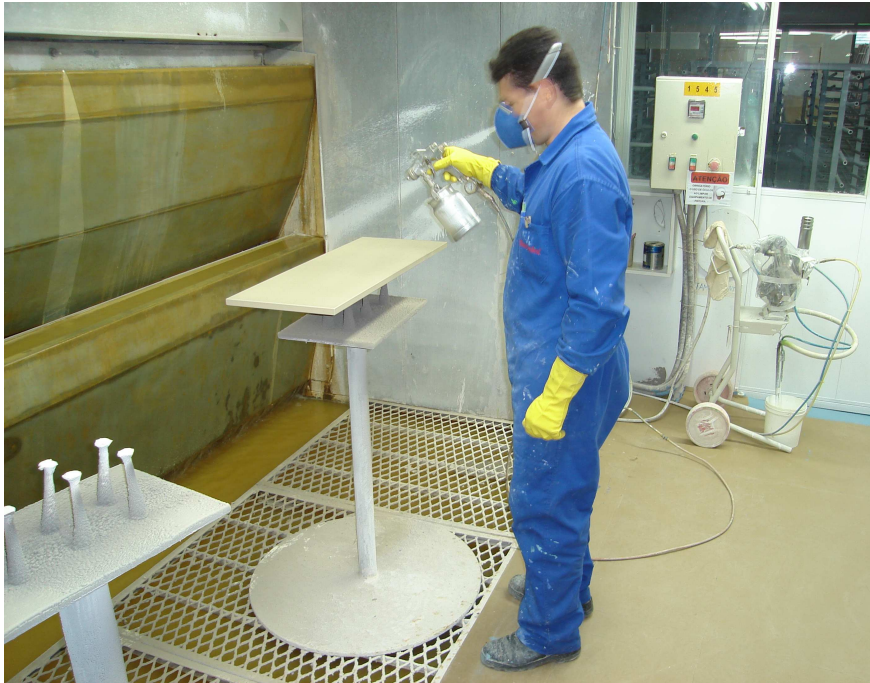
Figura 20: Pintura líquida com pistola pneumática Fonte: Foto tirada pelo autor
