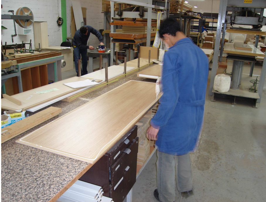
Figura 22: Bancada de montagem de tampos Fonte: Foto tirada pelo autor
