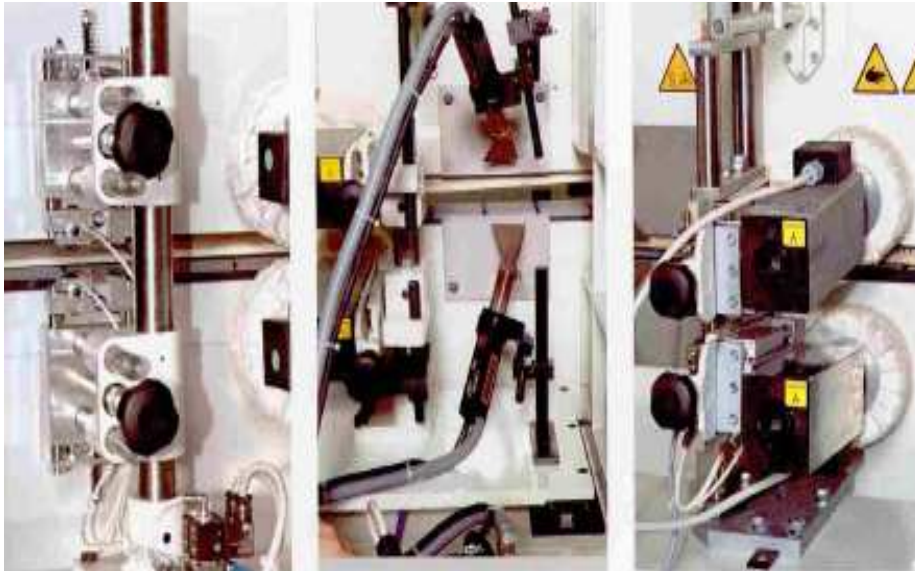
Figura 37: Dispositivo raspador de cola - Bordatriz Fonte: Foto tirada pelo autor
