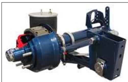
*Figura 3.3 – Sistema de freio ECO DRUM BPW. [www.bpw.com]*
