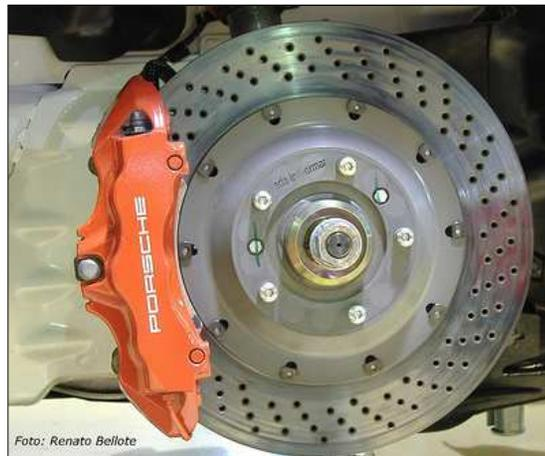
*Figura 3.1 – Sistemas de freio disco/pastilha para veículo de passageiros [fonte: farm4.static.flickr.com].*
