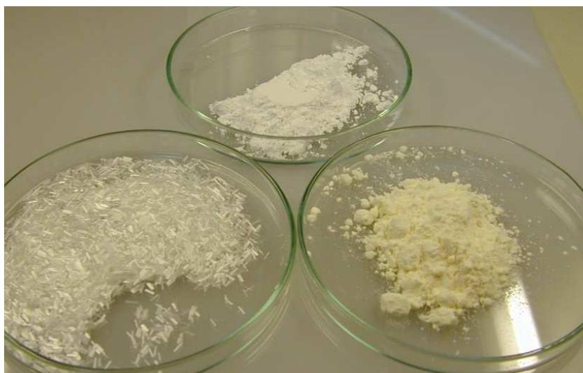
Figura 5.2 – Aspecto visual da fibra de vidro (à esq.), da resina fenólica (à dir.) e do silicato de zircônio (acima) utilizados na produção dos compósitos.
