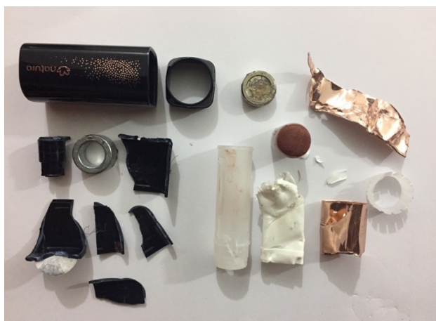
Figura 10: Componentes da embalagem de batom em barra da marca Natura
