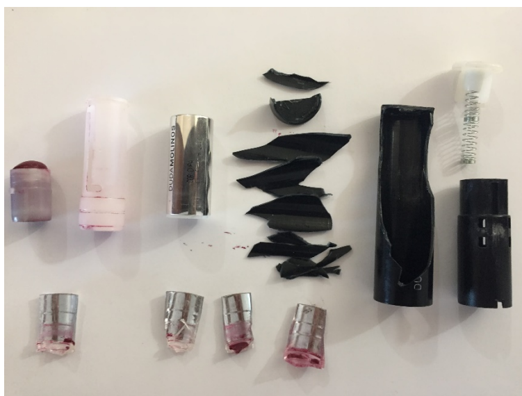
Figura 11: Componentes da embalagem de batom em barra da marca Duda Molinos
