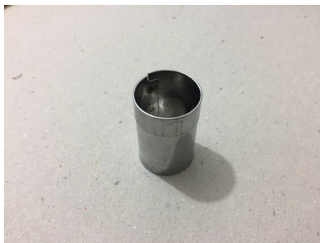
Figura 64: Faca no diâmetro exato para o corte de componente da embalagem
