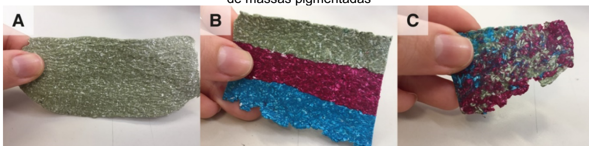
Figura 24: (A) Material pigmentado; (B) Aderência entre massas pigmentadas; (C) Mistura aleatória de massas pigmentadas
