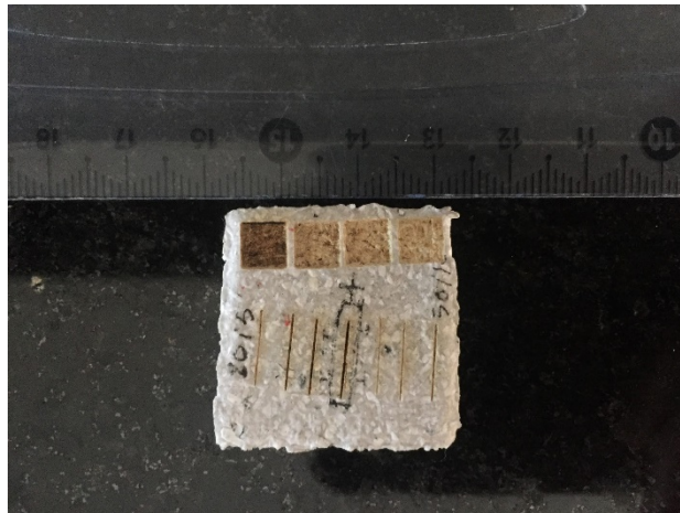
Figura 26: Amostra após gravação a laser com preenchimento, da esq. para dir.: 1, 2, 3 e 4
