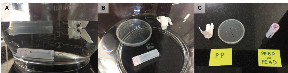
Figura 12: Teste de identificação de polímeros por densidade, em álcool (A e B), componentes identificados (C)
