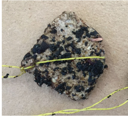
Figura 41: Amostra de material puro após 12 dias em composteira doméstica
