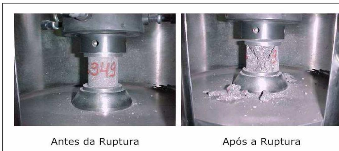
**Figura 4.3. Corpo-de-prova submetido a ensaio para a determinação da resistência mecânica à compressão, segundo a norma NBR 6224.**
