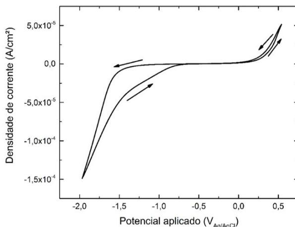
**Figura 1.** Voltamograma conduzido na célula de deposição eletroassistida com substrato de alumínio AA 1100 em sol-gel de TEOS a partir da varredura de potenciais entre -1,5 V e +1,0 V a partir do OCP.
