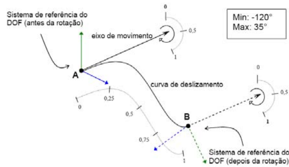
Figura 3.4: Esquema de movimentação do joelho humano: a origem do sistema de referência do elemento DOF desliza ao longo de uma curva ao mesmo tempo que rotaciona (MACIEL; NEDEL; FREITAS, 2002).
