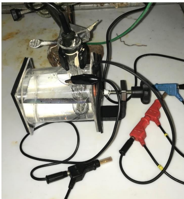
Figura 24. Célula utilizada para a realização da voltametria cíclica.
