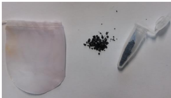
Figura 17. Catalisador de Pd/In e suporte utilizado nos experimentos.
