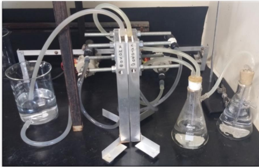
Figura 10. Célula eletrolítica A com lavador de gases.
