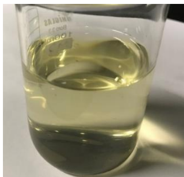
Figura 58. Aspecto da solução de nitrato de sódio de concentração inicial de 600 \text{ mg L}^{-1} após a utilização de eletrodos na forma de esponja de cobre.
