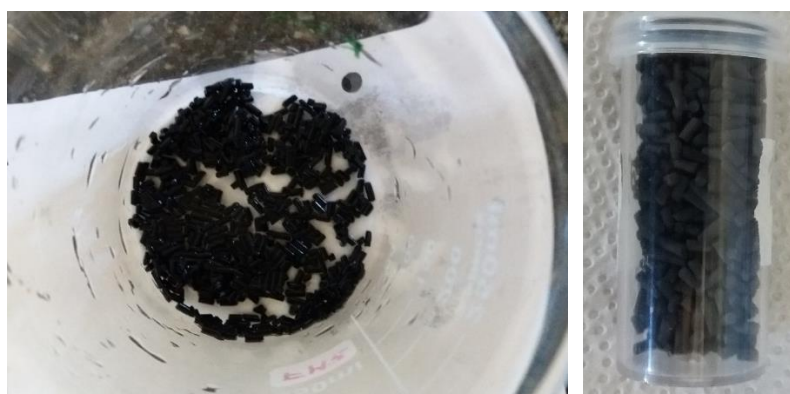
Figura 18. Catalisador 2,5% de paládio impregnado em alumina.
