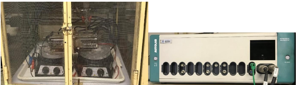
Figura 26. Célula utilizada no sistema experimental em modo potenciostático utilizando Gaiola de Faraday e o potenciostato Autolab.
