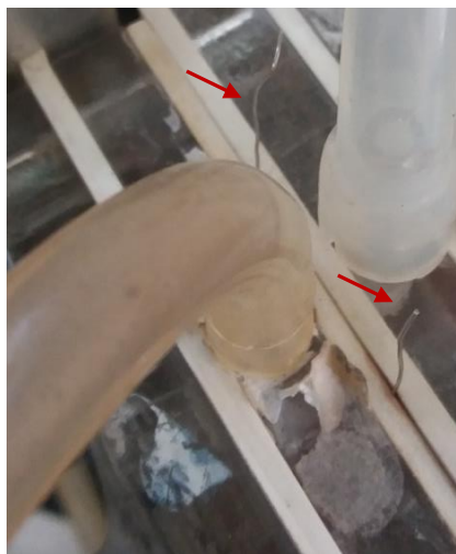
Figura 21. Célula eletrolítica com fios de platina para a realização da CVC na membrana catiônica.
