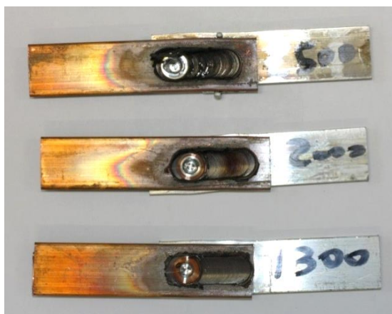
Figura 73 – Falhas causadas devido à geração excessiva de calor em rotações elevadas
