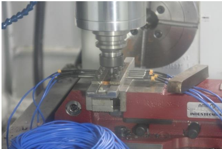
Figura 16– Soldagem das amostras e esquema mostrando as posições dos sensores de temperatura
