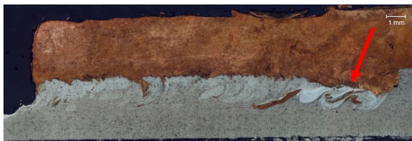
Figura 25 – Macrografia da seção longitudinal de uma solda mostrando o ACI 1000 rpm.
