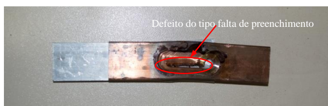
Figura 54 – Defeito de cavidade associada a baixas rotações com avanço excessivo.
