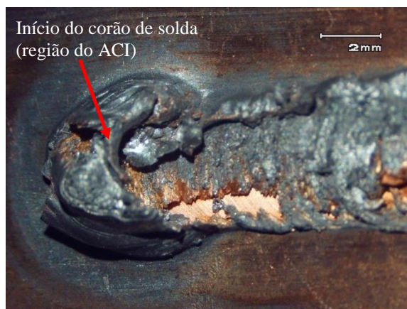
Figura 80 – Solda com ACI (1000 rpm) após ensaio de cisalhamento
