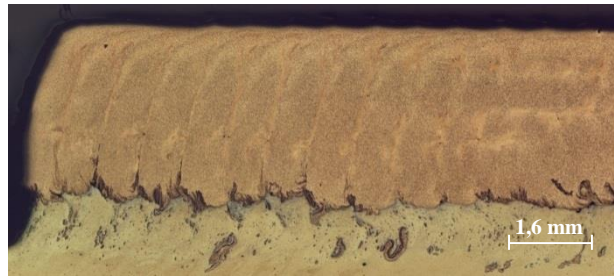
Figura 57 – Corte longitudinal de solda produzida a 1000 rpm com ACI
