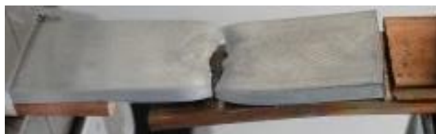
Figura 68 – Fratura em ensaio de fadiga de uma junta soldada (C(ACI)1000 rpm)
