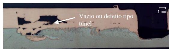
Figura 51 – Macrografia da seção longitudinal de uma solda produzida com baixa rotação e sem o movimento ACI a 800rpm, mostrando a presença de vazios.
