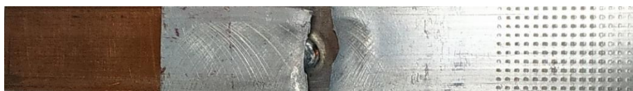
Figura 66 – Junta soldada fraturada após ensaio de cisalhamento.
