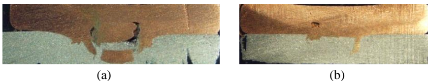
Figura 71 – Seção transversal de soldas produzidas com ACI a: (a) 800 rpm e (b) 1000 rpm.
