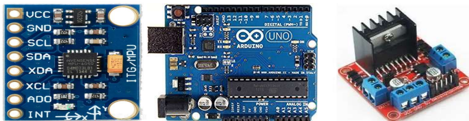
Figura 6 - (Da esquerda para a direita) Unidade de medida inercial MPU6050, Placa de desenvolvimento com o microcontrolador ATmega 328P e Driver controlador L298N
