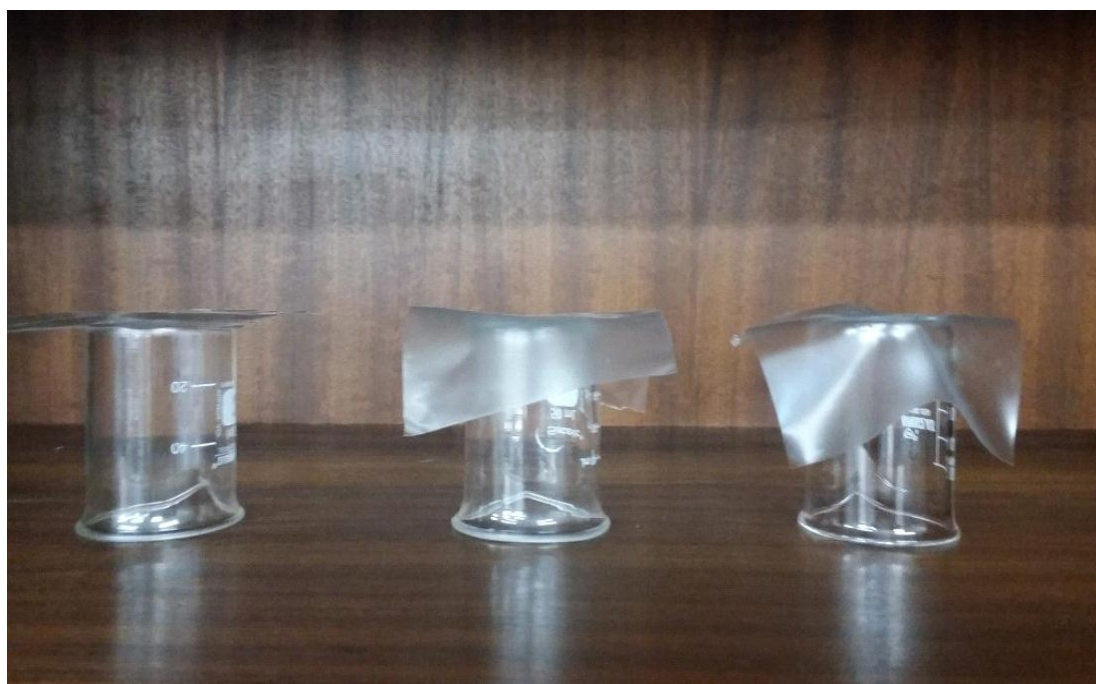
Figura 9 Influência do glicerol na flexibilidade dos filmes. Amostras contendo 0,5% de glicerol (G0.50T0.75T), 1,25% de glicerol (G1.25T0.75T) e 2,00% de glicerol (G2.00T0.75T), com adição de 0,75% de TEOS com etapa de pré-hidrólise.
