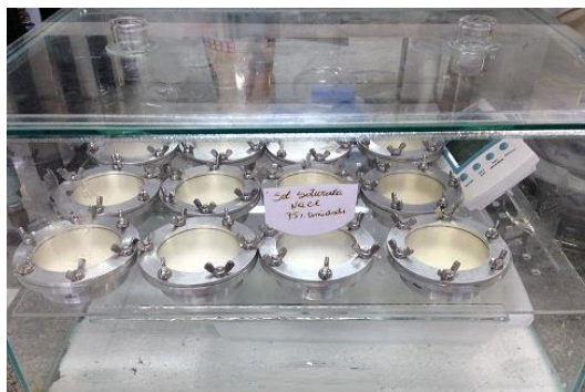
Figura 6 Células de permeação armazenadas em cuba de vidro para análise de PVA
