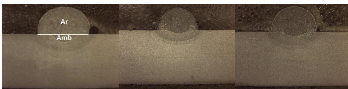
Figura 4.1– Cordões de solda gerados pelo método Box-Behnken com as combinações 7, 8 e 11
