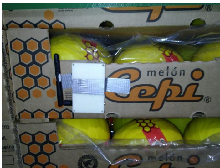
Figura 16 – Nó sensor instalado em caixa com melões
