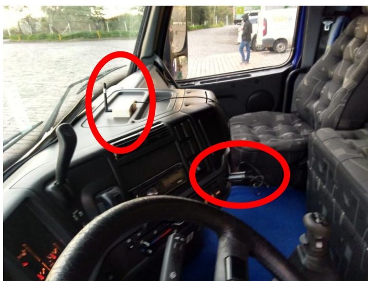
Figura 15 – Nó coletor instalado na cabine ligado à saída 12v
