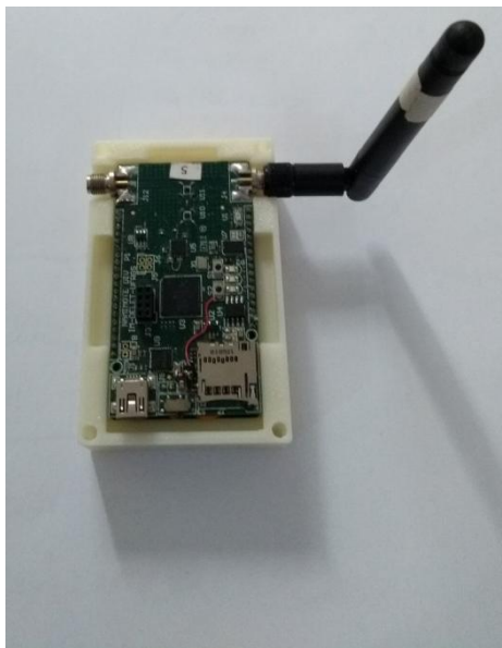
Figura 10 – Hardware inserido no invólucro inferior
