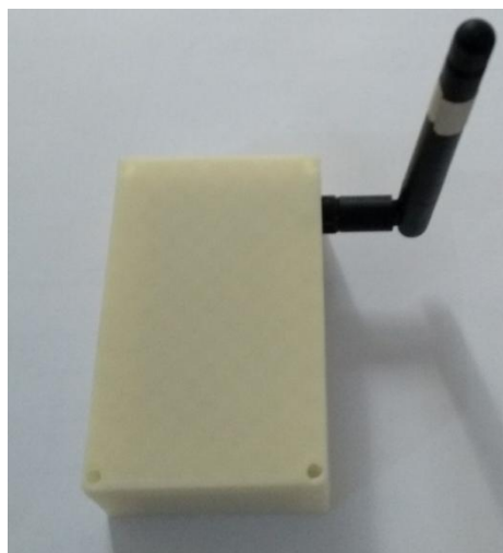
Figura 11 – Hardware inserido no invólucro completo
