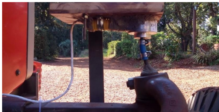
Figura 10: Encoder instalado. Fonte: Autor.
