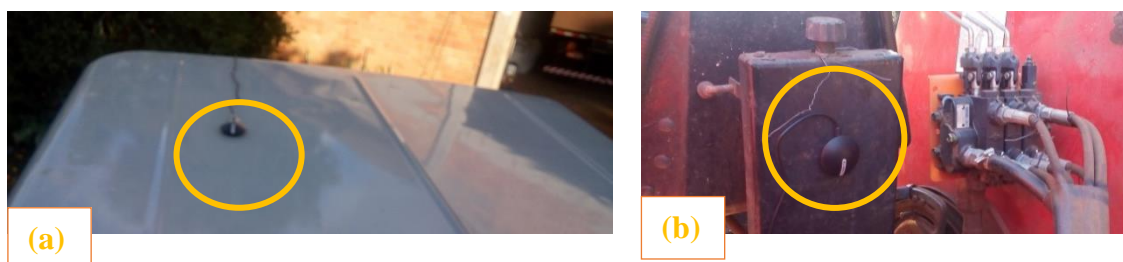
Figura 6: Fixação do receptor GPS nos tratores MF4292(a) e MF275(b). Fonte: Autor.
