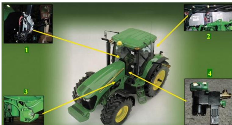
Figura 1: Piloto automático e seus componentes: (1) sensor de posição, (2) controlador, (3) sensor de ângulo das rodas, (4) válvula eletro-hidráulica. Fonte: Oliveira (2009).
