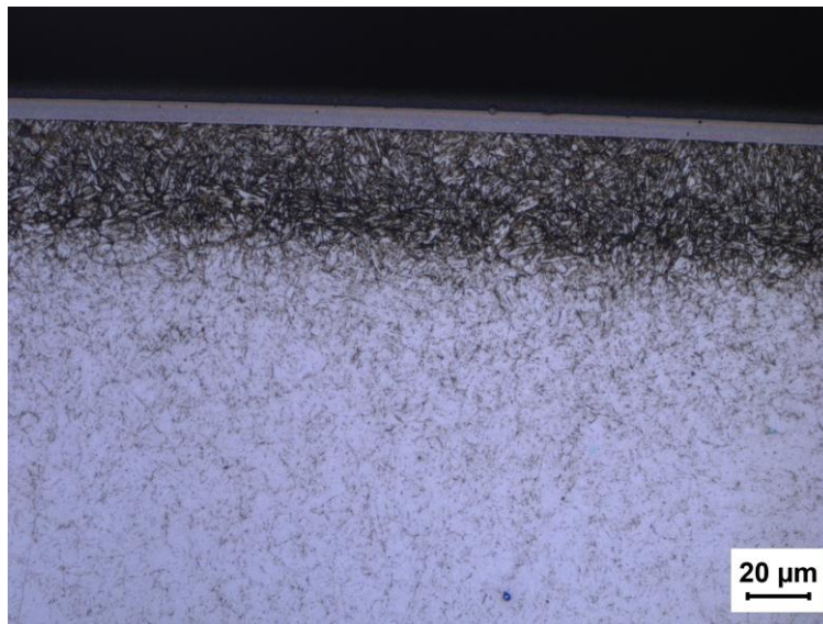
Figura 26 - AISI H13 + Revestimento Dúplex, 500x, ataque químico: Nital 3%.
