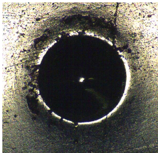
Figura 28 - Resultado do teste de adesão conforme Norma VDI 3198.
