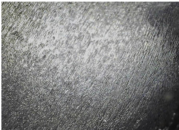
Figura 37 - Ampliação (50X) do desgaste da ferramenta com nitretação gasosa
