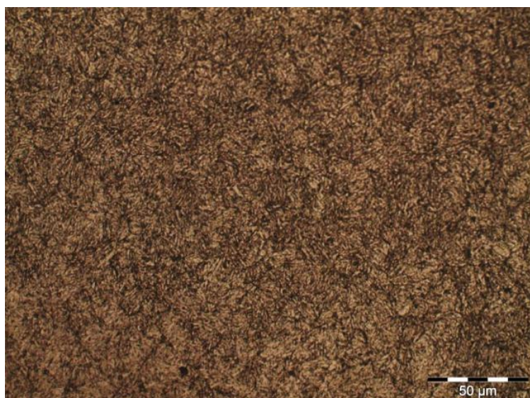
Figura 23 - Microestrutura do aço AISI H13, 500X, ataque químico: Nital 3%.
