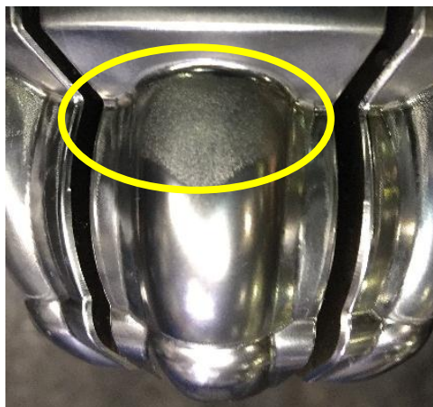
Figura 30 - Ferramenta com aço AISI H13 sem revestimento no final de sua vida útil.
