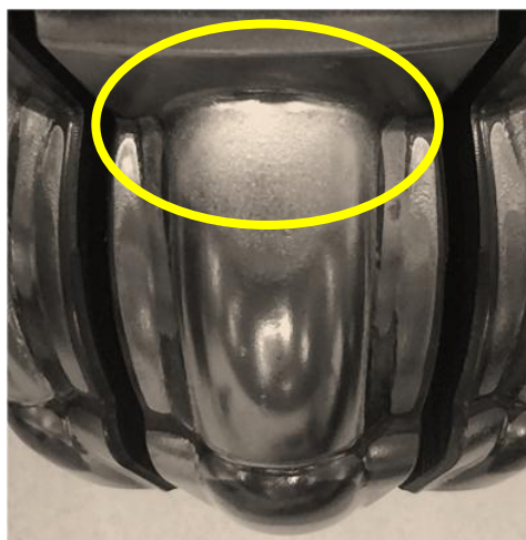
Figura 34 - Ferramenta com Nitretação Gasosa no final de sua vida útil
