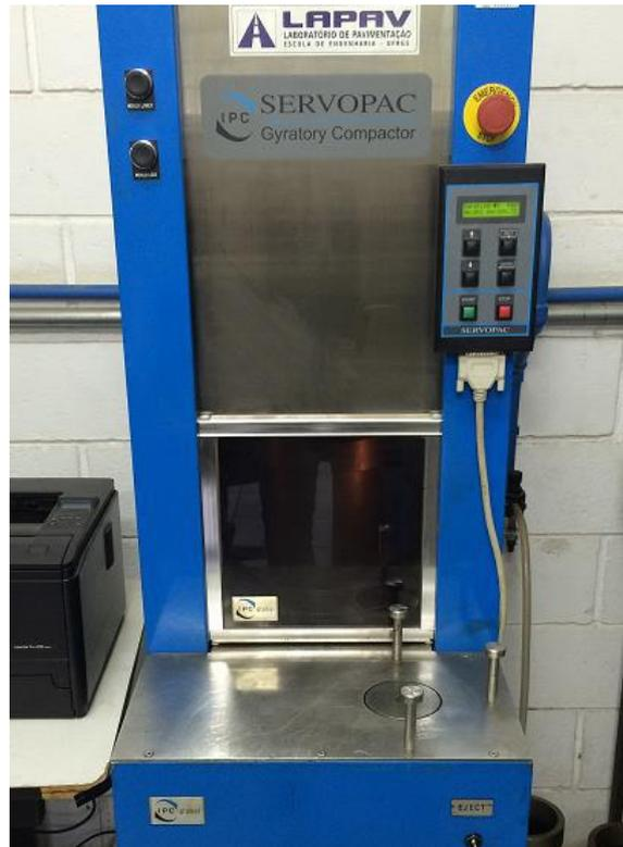
Figura 24 – Compactador Giratório Superpave
