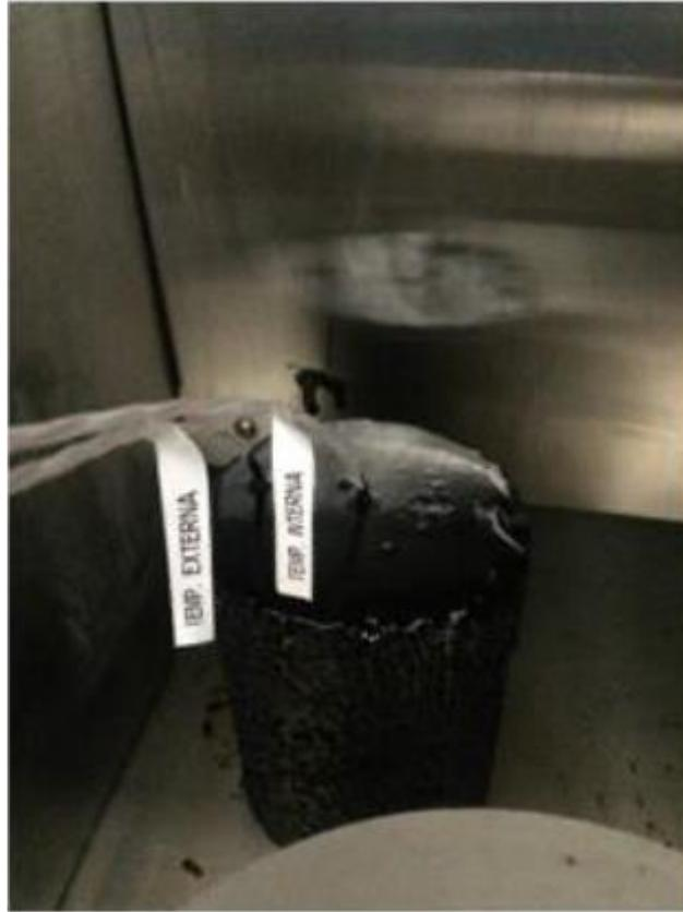
Figura 32 – CP *dummy* com sensores de temperatura interna e externa
