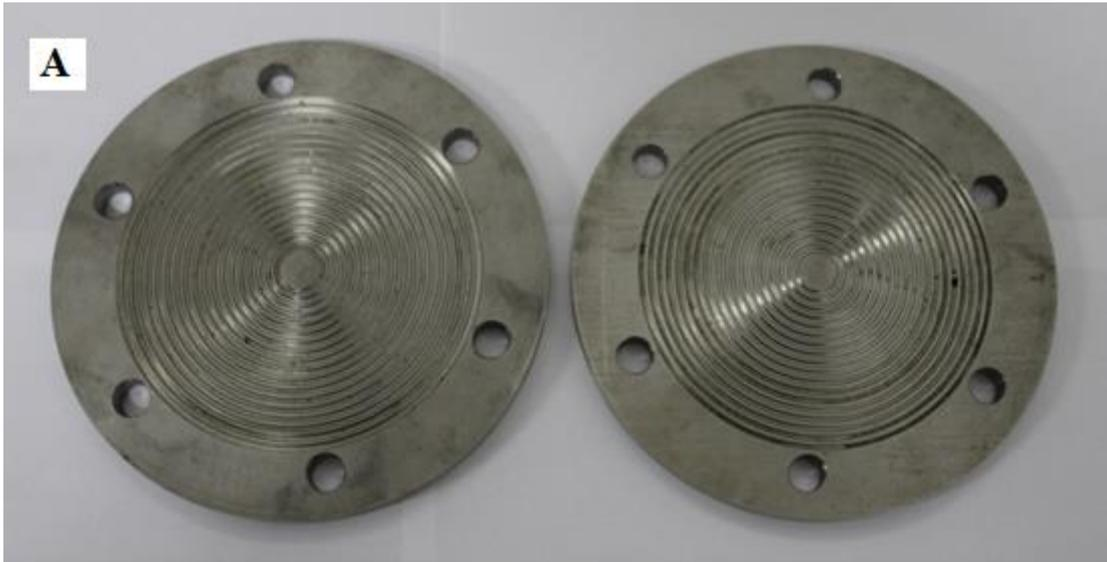
Figura 26 – Pratos inferior e superior de colagem dos CPs
