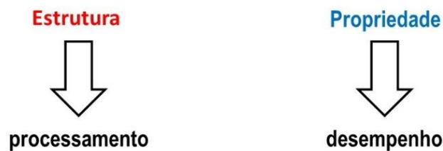
Figura 5: Processamento e desempenho: variáveis que alteram a estrutura e a propriedade dos materiais, respectivamente.
