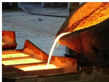
Figura 43: Processo de fundição: derramamento do metal fundido em um molde.
