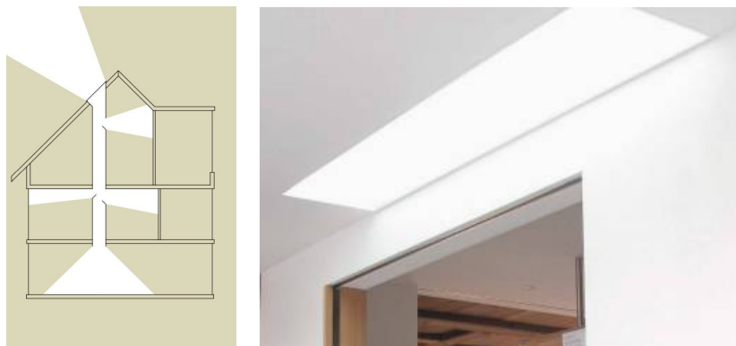
Figura 88 - Sistema de captação de luz solar.
