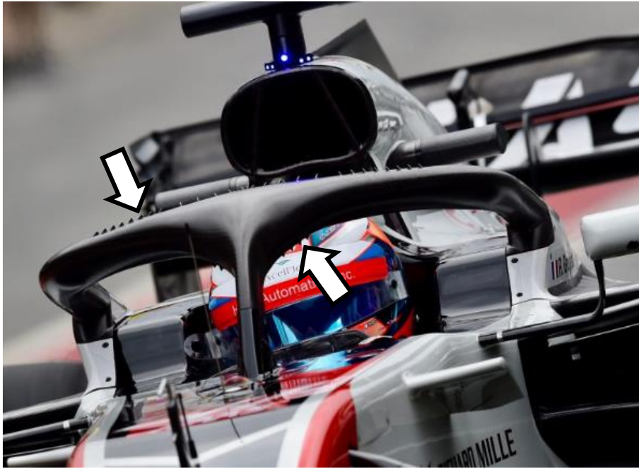
Figura 1.5 - Geradores vórtices montado no Halo (dispositivo de proteção do cockpit ) em testes do veículo de F1 Haas VF-18 [Adaptado de Formula 1, 2018].
