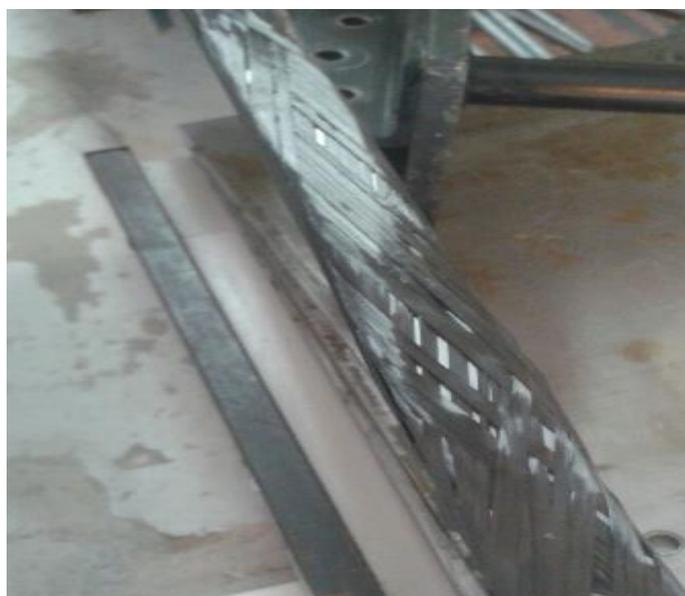
Figura 5.2– Resultado do teste do enrolamento com ângulo de  $10^\circ$ .
