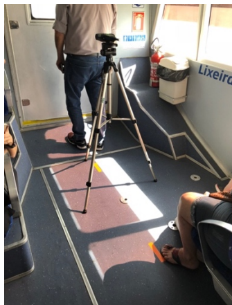
Figura 4.2 - Decibelímetro posicionado no tripé a 1,2 metros do solo. Fonte: do autor.
