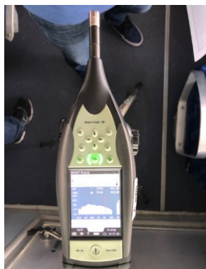
Figura 4.1 - Decibelímetro da marca Brüel and Kjaer, modelo 2250 utilizado nas medições. Fonte: do autor.
