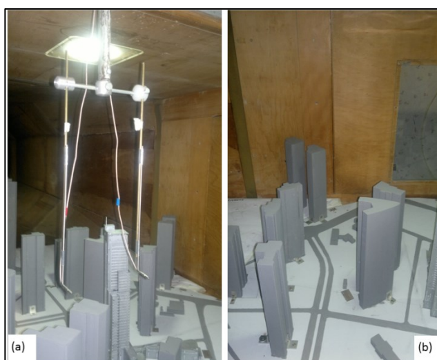
Figura 71: (a) detalhe do conjunto suporte/sonda e (b) modelo na câmara de ensaios do túnel
