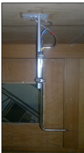
Figura 69: tubo de Pitot no interior do túnel de vento
