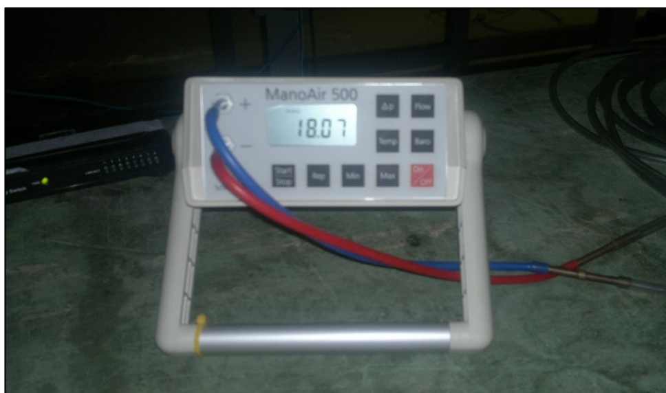
Figura 51: ManoAir e mangueiras de conexão aos anéis piezométricos.
