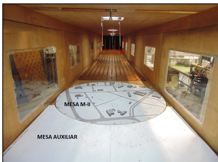
Figura 55: Mesa M-II e Mesa Auxiliar na câmara de testes do túnel de vento
