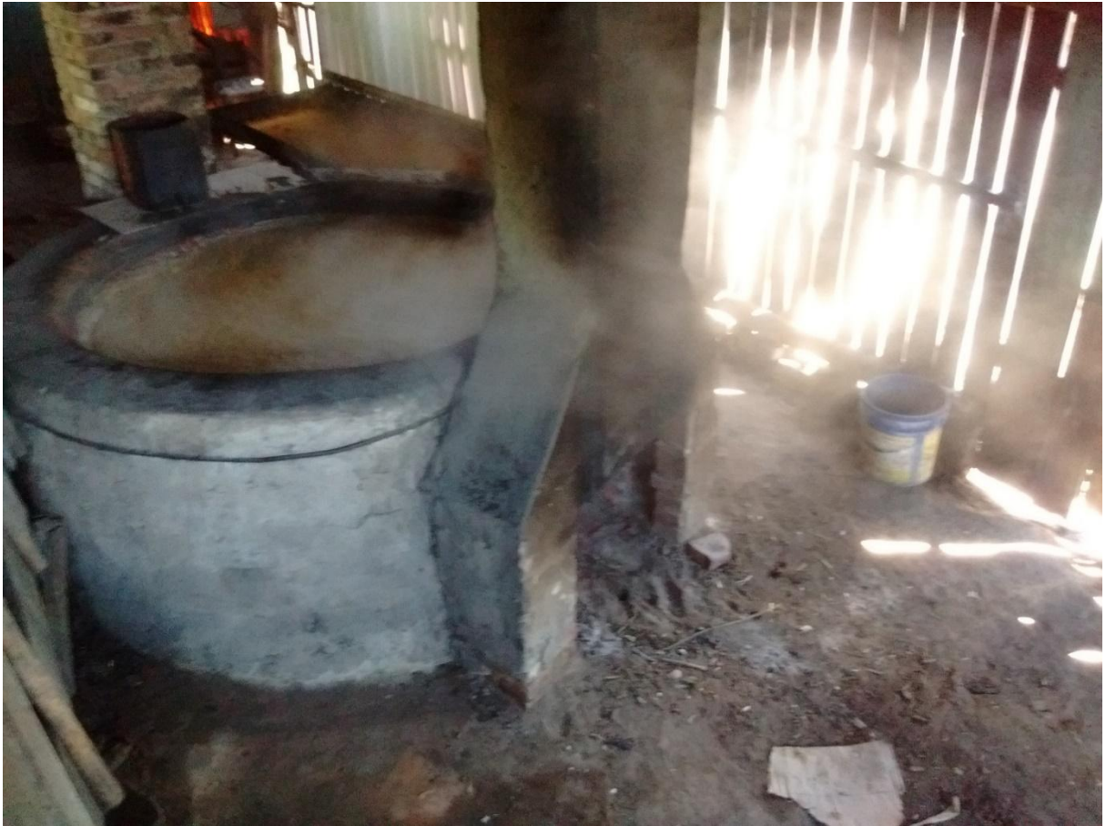
Figura 8 – Agroindústria informal de açúcar mascavo e melado na etapa de cozimento do caldo de cana
