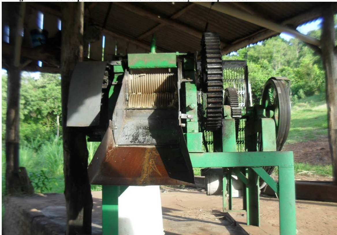
Figura 7 – Moenda para extrair o caldo da cana-de-açúcar adquirida com recursos via FEAPER
