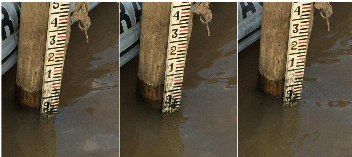
Figura 43 - Fotografias da régua linimétrica para verificação da altura da lâmina d'água
