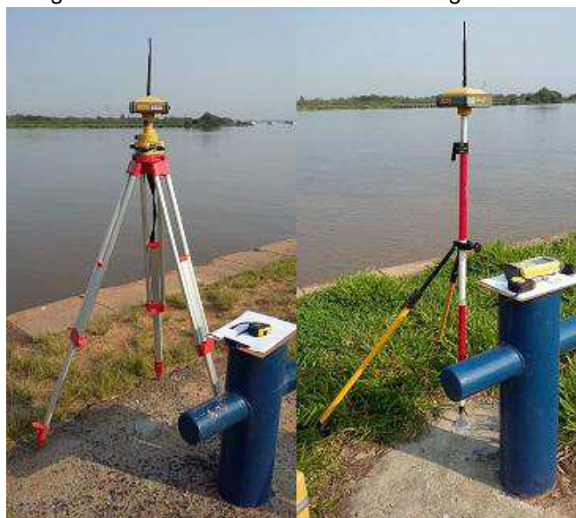
Figura 12 - Posicionamento dos marcos geodésicos
