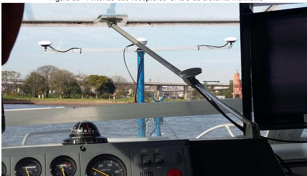
Figura 25 - Antenas dos receptores GNSS do sistema multifeixe
