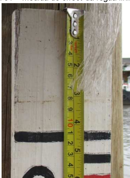
Figura 31 – Medida do offset da régua linimétrica
