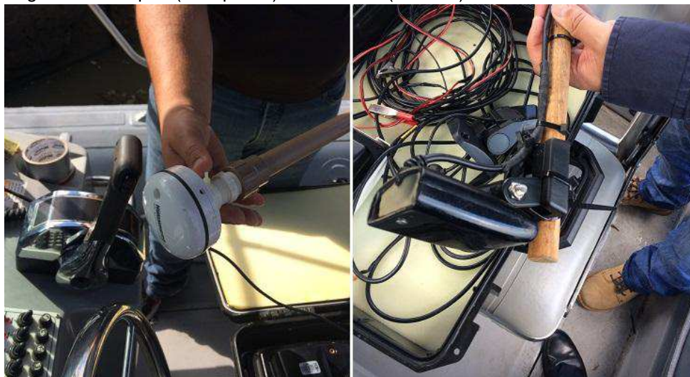
Figura 8 - Receptor (à esquerda) e transdutor (à direita) do ecobatímetro monofeixe
