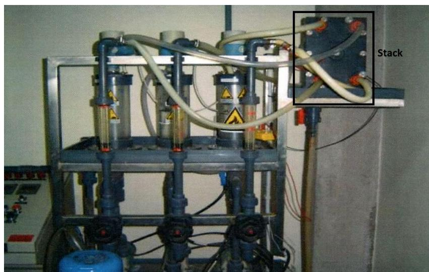
Figura 20 - Planta Piloto de eletrodialise com *stack* montado.
