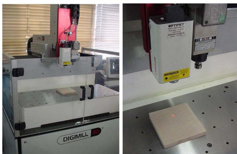
Figura 3.8 – Scanner Tridimensional Laser do LdSM / UFRGS [Adaptado de Silva, 2006]
