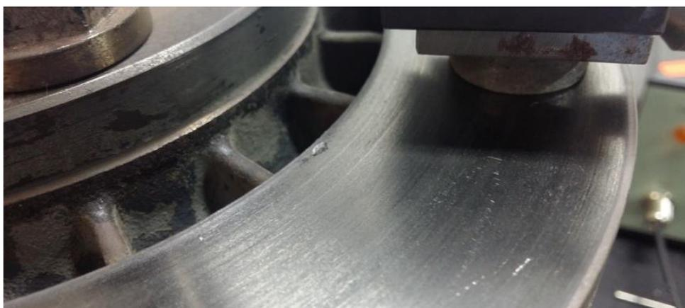
Figura 5.6 – Condição da superfície do disco mantida em todos os ensaios realizados.
