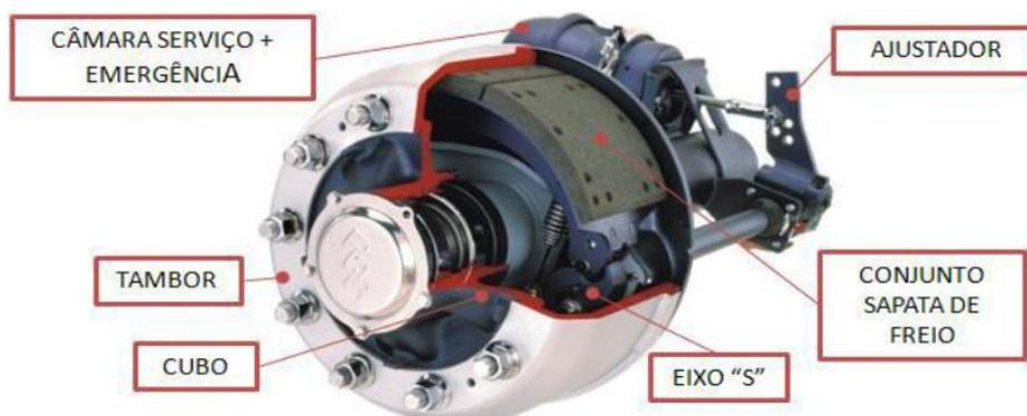
Figura 2.1 – Sistema de freio a tambor com identificação dos principais componentes.
