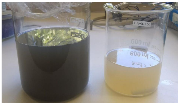
Figura 3. 25- Aspecto visual de antes (esquerda) e depois (direita) do tratamento do efluente com H_2O_2/UVC .
