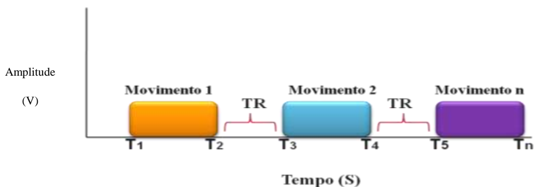
Figura 23 Temporização dos movimentos de um só canal.
