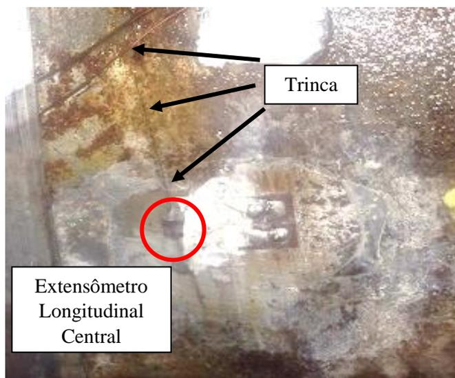
Figura 36: Região central do tubo indicando a presença da trinca transpassando um dos extensômetros centrais. Fonte: O autor.
