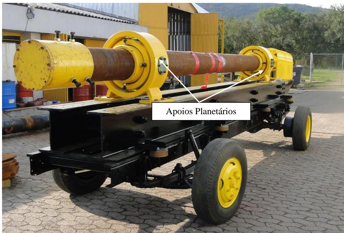
Figura 12: Máquina para testes de fadiga por ressonância em tubos, com o conceito de apoios planetários. Fonte: o autor.
