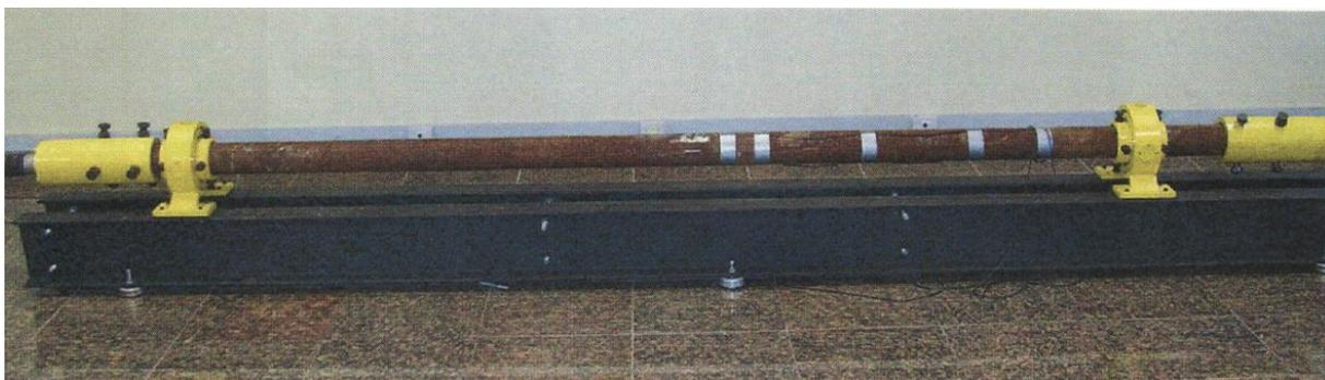
Figura 8: Bancada para testes de fadiga por ressonância em tubos rígidos. Fonte: POPE et al. (2004).
