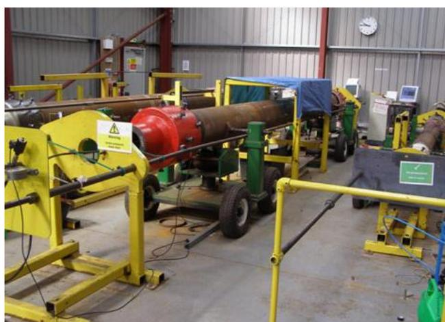
Figura 9: Exemplo de máquina utilizada para testes de fadiga por ressonância em tubos rígidos. Fonte: ZHANG e MADDOX (2012).
