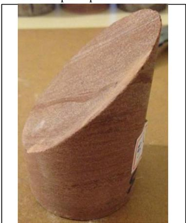
Foto estratificação corpo de prova
