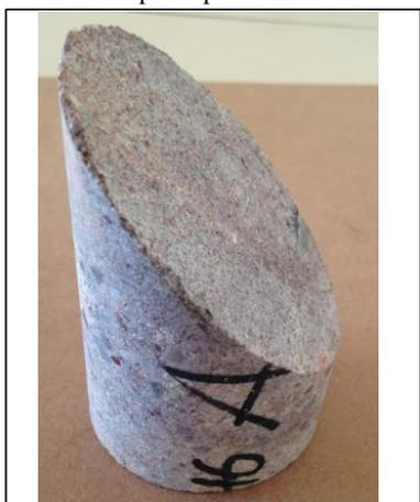
Foto estratificação corpo de prova
