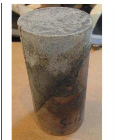
Foto corpo de prova moldado
