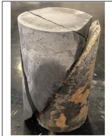
Foto corpo de prova rompido
