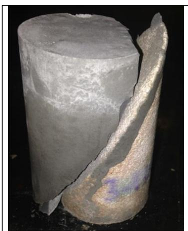
Foto corpo de prova rompido
