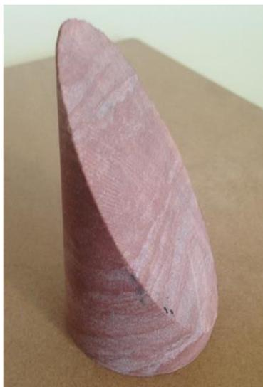
Figura 4.10 – Cortes em direção oposta aos planos estratigráficos da rocha
