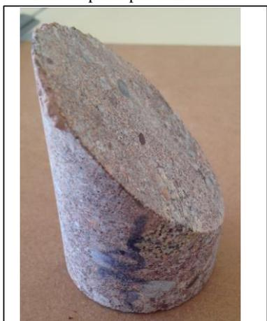
Foto estratificação corpo de prova
