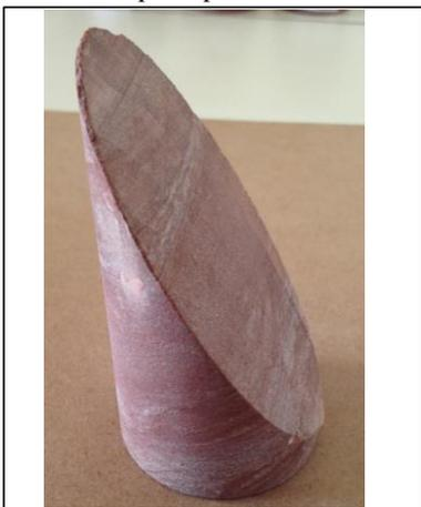
Foto estratificação corpo de prova
