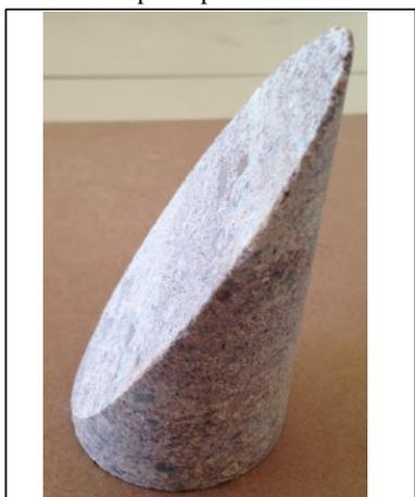
Foto estratificação corpo de prova
