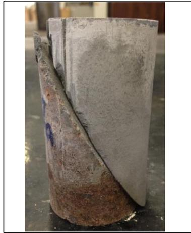
Foto corpo de prova rompido
