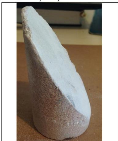
Foto estratificação corpo de prova
