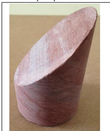
Foto estratificação corpo de prova
