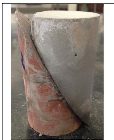
Foto corpo de prova rompido
