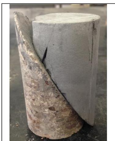
Foto corpo de prova rompido
