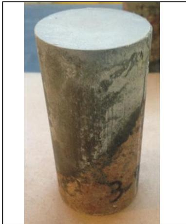
Foto corpo de prova moldado
