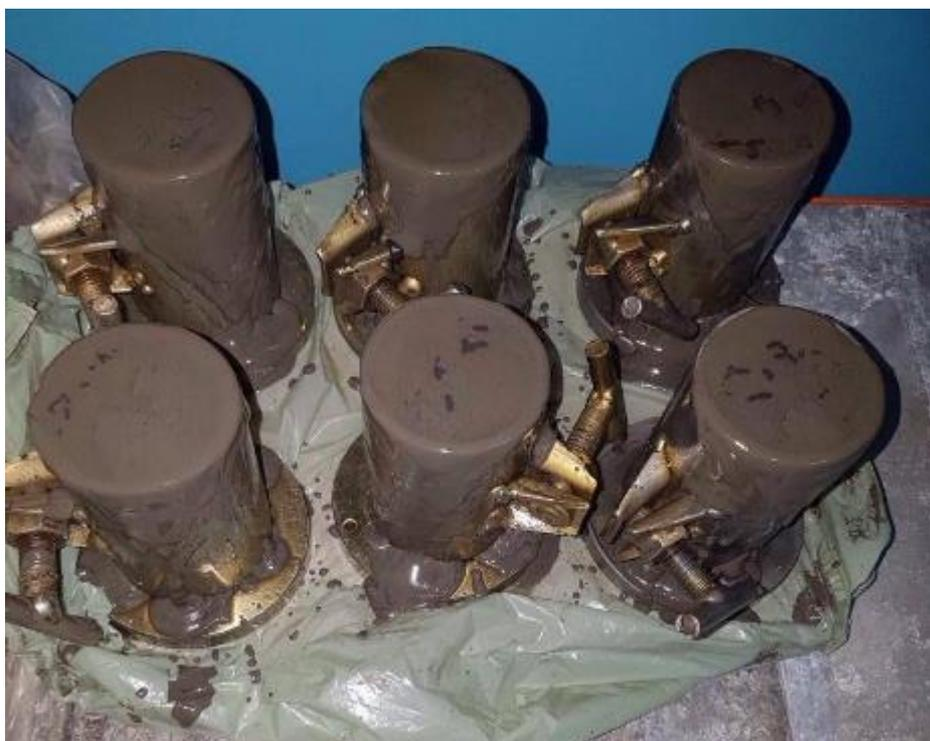
Figura 4.14 – Corpos de prova de nata de cimento imediatamente após a moldagem
