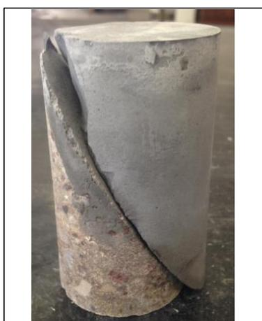
Foto corpo de prova rompido
