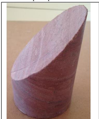
Foto estratificação corpo de prova
