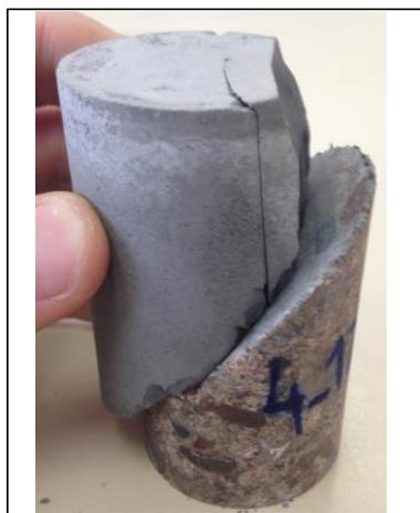
Foto corpo de prova rompido
