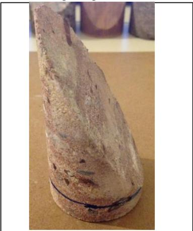
Foto estratificação corpo de prova
