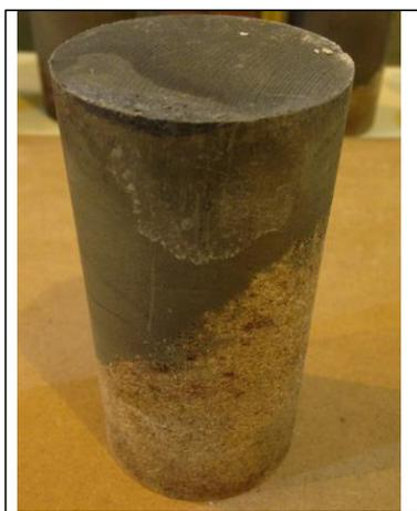
Foto corpo de prova moldado
