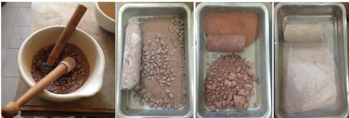
Figura 4.3 – Apiloamento manual: amostras naturais e após o apiloamento
