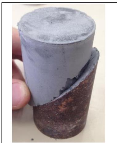
Foto corpo de prova rompido
