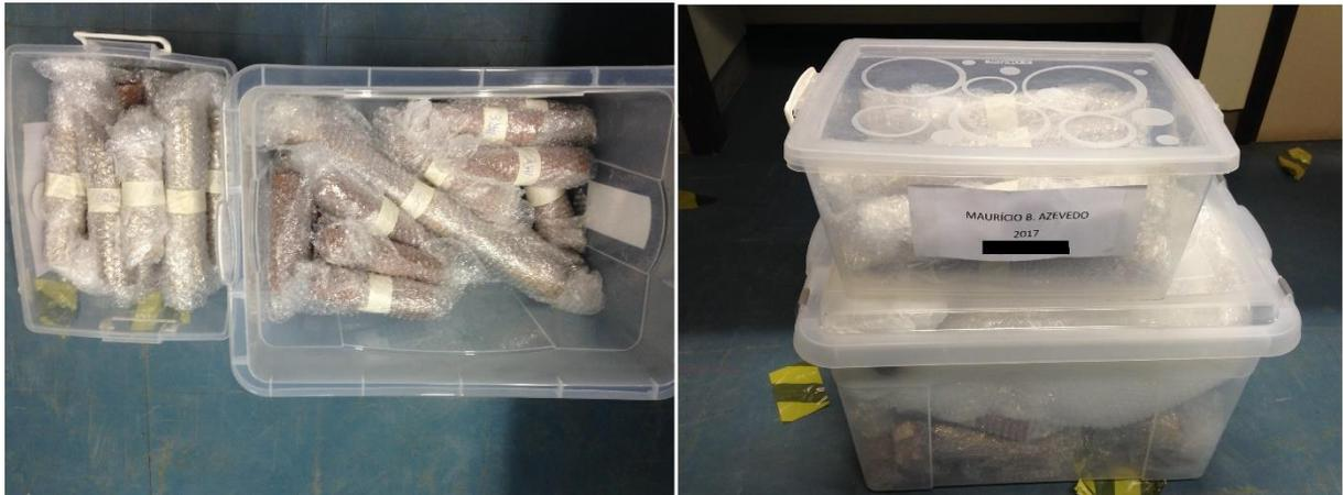
Figura 4.2 – Armazenamento dos testemunhos para transporte
