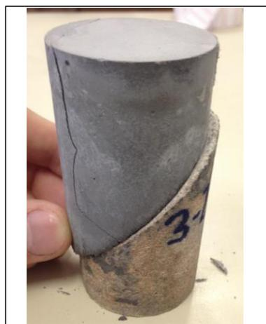
Foto corpo de prova rompido
