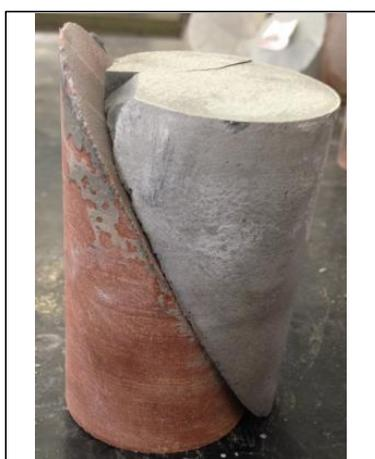
Foto corpo de prova rompido
