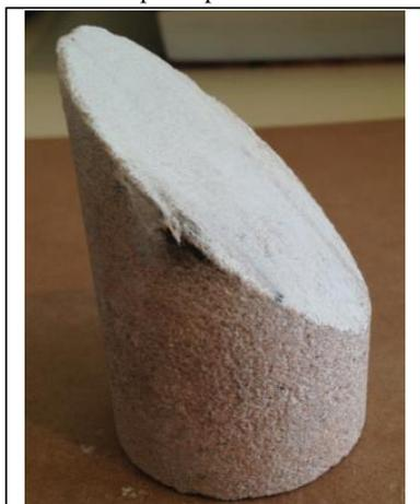
Foto estratificação corpo de prova
