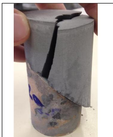
Foto corpo de prova rompido
