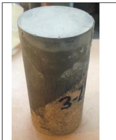
Foto corpo de prova moldado
