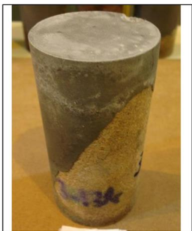
Foto corpo de prova moldado
