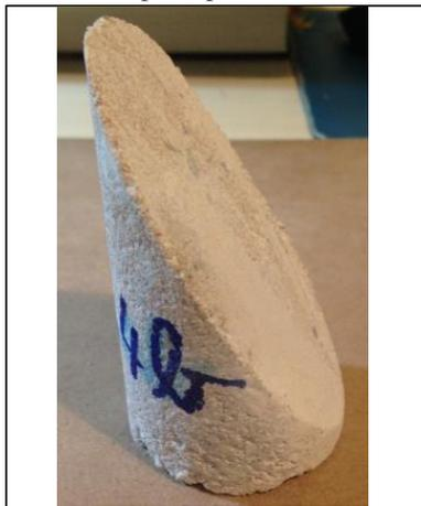
Foto estratificação corpo de prova
