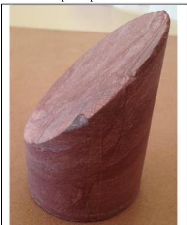
Foto estratificação corpo de prova
