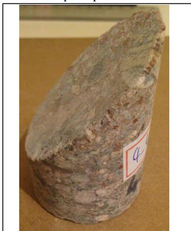
Foto estratificação corpo de prova
