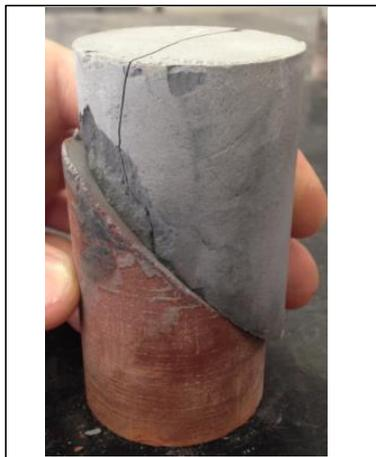
Foto corpo de prova rompido
