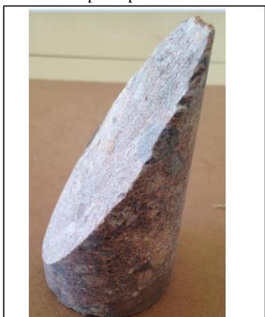
Foto estratificação corpo de prova
