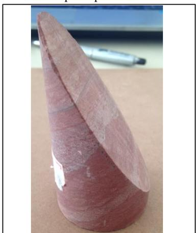
Foto estratificação corpo de prova
