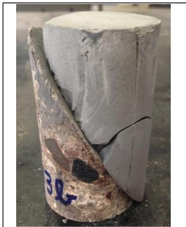
Foto corpo de prova rompido
