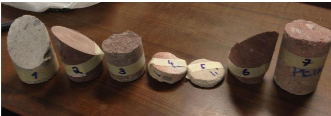
Figura 4.4 – Amostras de onde foram obtidas as lâminas delgadas
