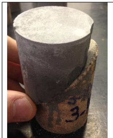
Foto corpo de prova rompido
