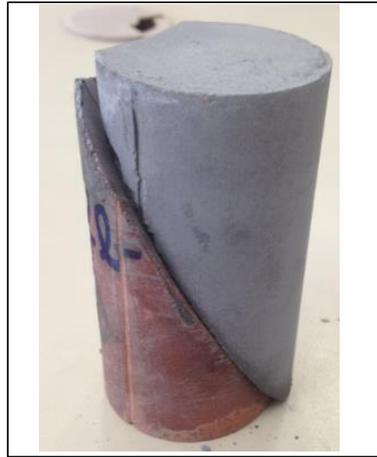
Foto corpo de prova rompido
