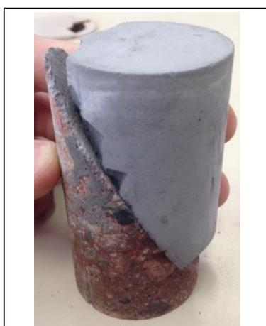
Foto corpo de prova rompido
