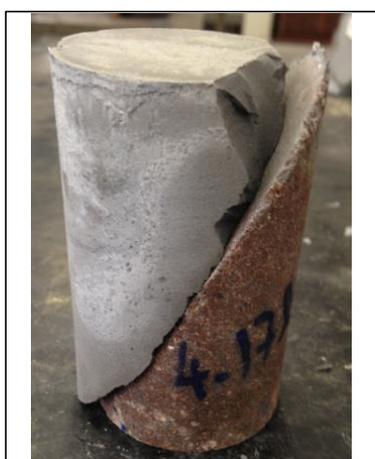
Foto corpo de prova rompido
