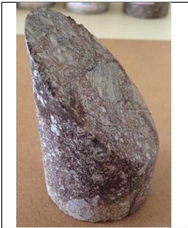
Foto estratificação corpo de prova
