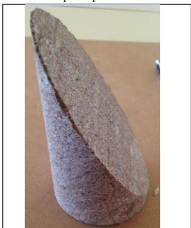
Foto estratificação corpo de prova
