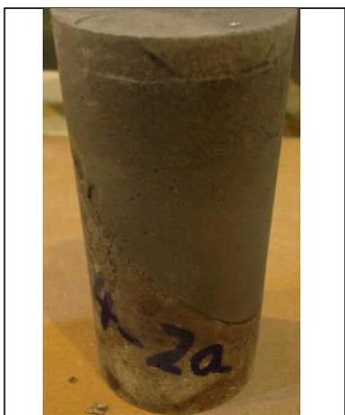
Foto corpo de prova moldado
