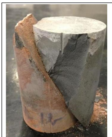
Foto corpo de prova rompido
