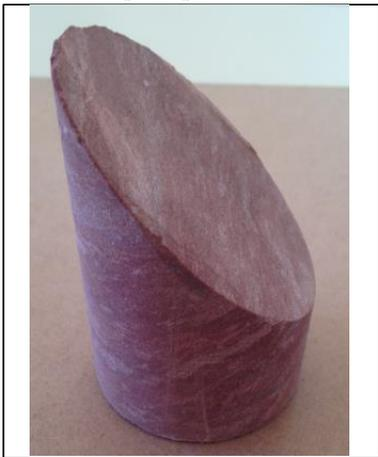
Foto estratificação corpo de prova
