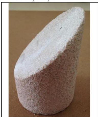
Foto estratificação corpo de prova
