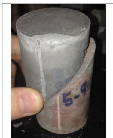
Foto corpo de prova rompido
