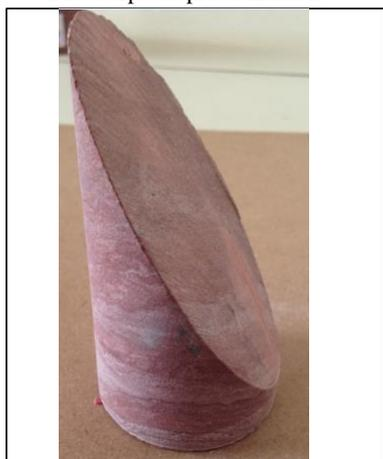
Foto estratificação corpo de prova
