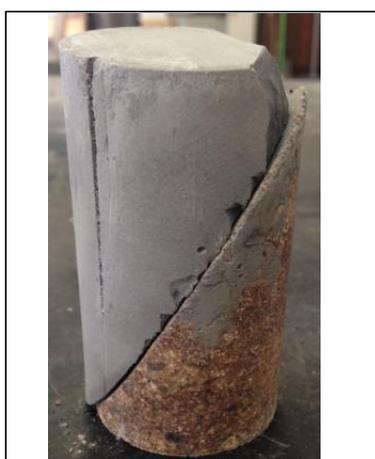
Foto corpo de prova rompido
