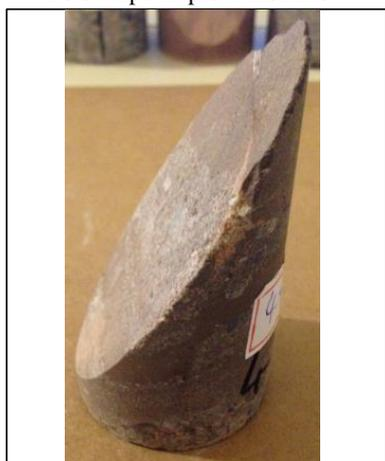
Foto estratificação corpo de prova
