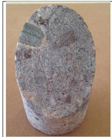
Foto superfície de corte do corpo de prova
