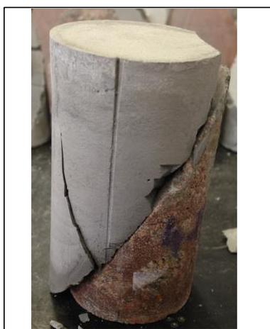
Foto corpo de prova rompido
