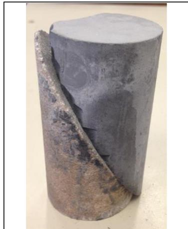
Foto corpo de prova rompido
