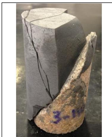
Foto corpo de prova rompido
