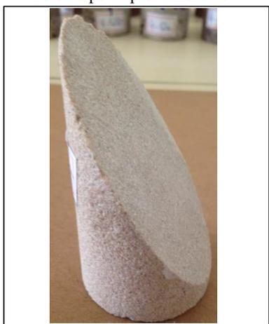
Foto estratificação corpo de prova
