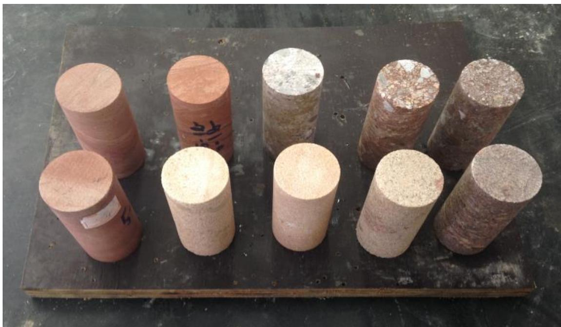
Figura 4.11 – Corpos de prova de rocha para ensaios de resistência à compressão simples
