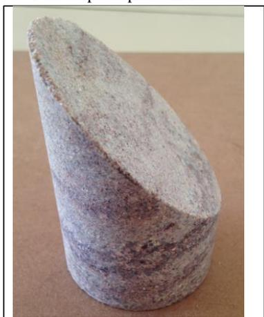
Foto estratificação corpo de prova
