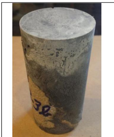
Foto corpo de prova moldado
