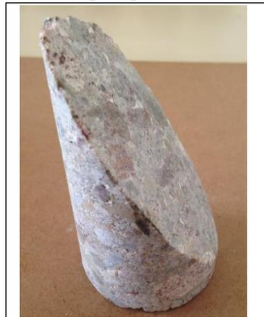
Foto estratificação corpo de prova
