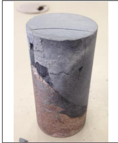
Foto corpo de prova rompido
