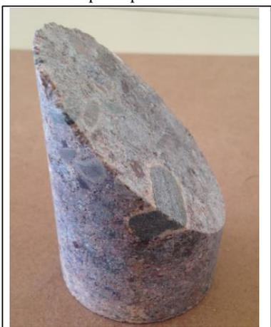
Foto estratificação corpo de prova
