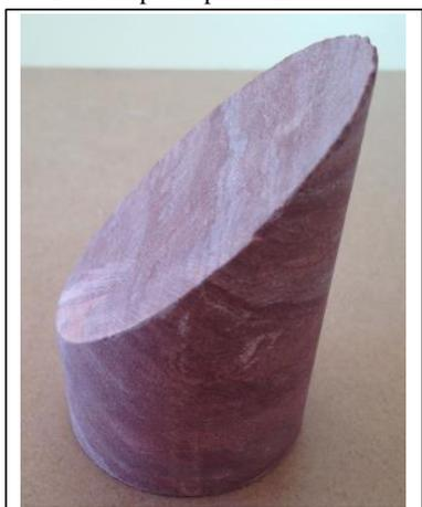
Foto estratificação corpo de prova
