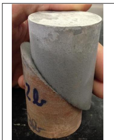
Foto corpo de prova rompido
