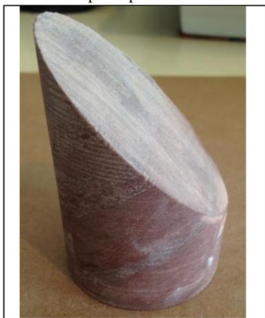
Foto estratificação corpo de prova
