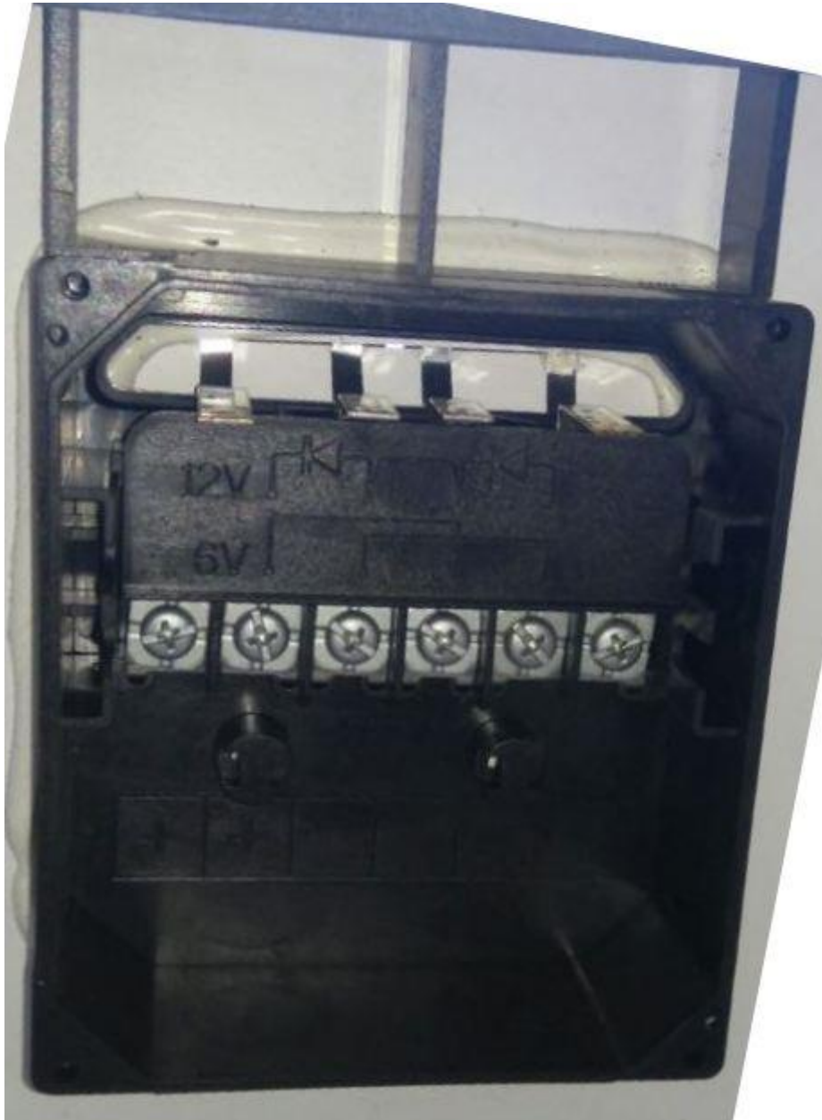
Figura 15 - Caixa de conexão traseira de um módulo fotovoltaico de silício
