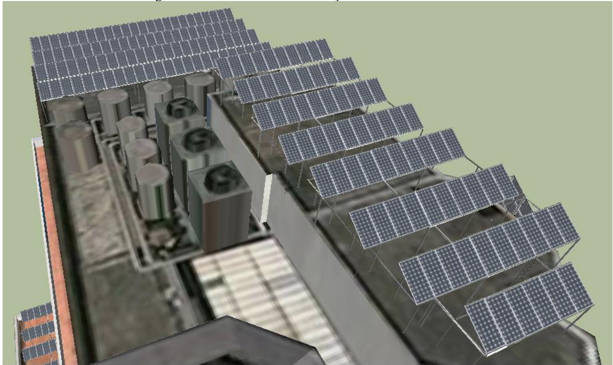
Figura 28 - Detalhe em 3D do terraço com módulos instalados
