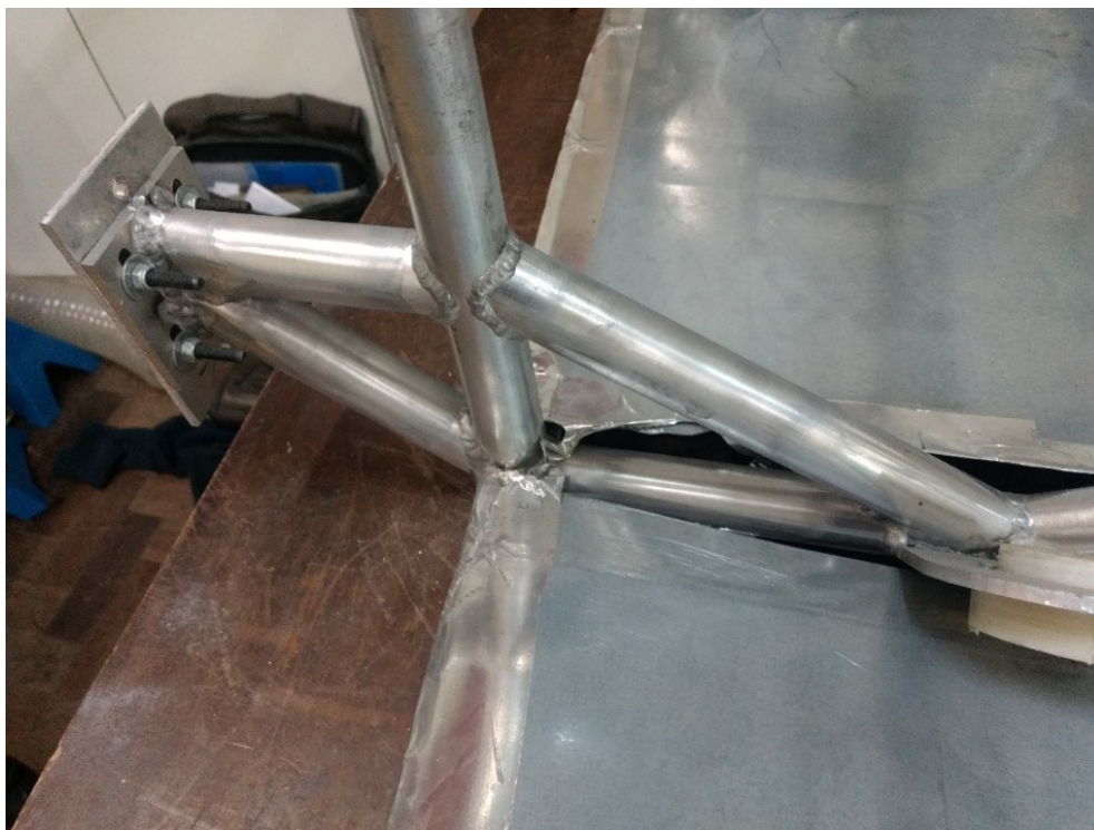
Figura 26: Detalhe da suspensão dianteira esquerda após lixamento.
