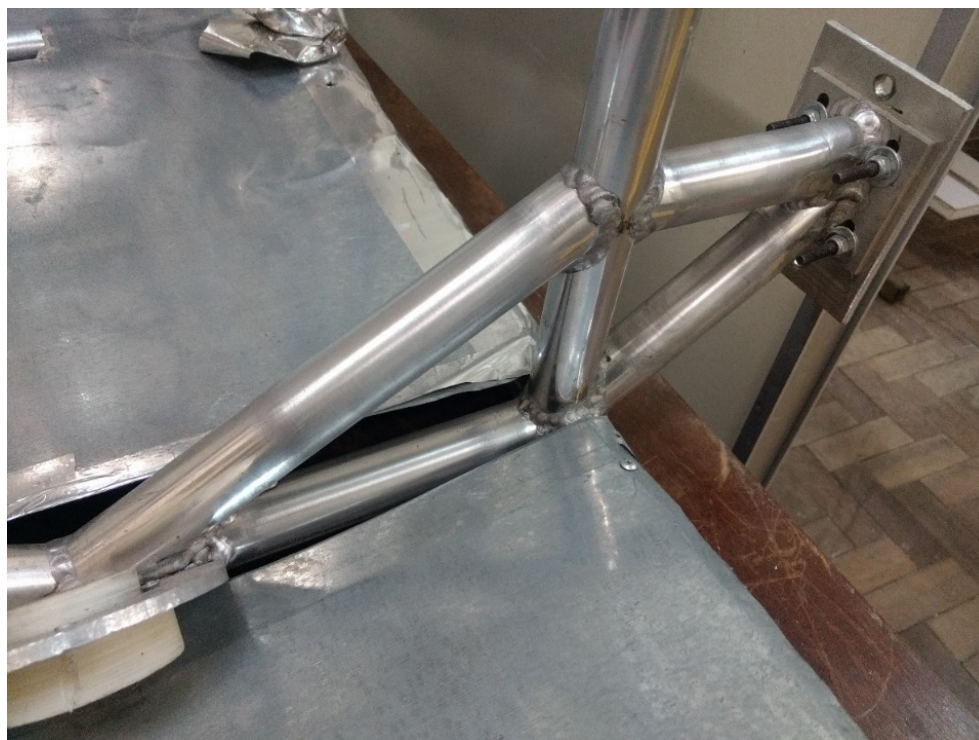
Figura 27: Detalhe da suspensão dianteira direita após lixamento.
