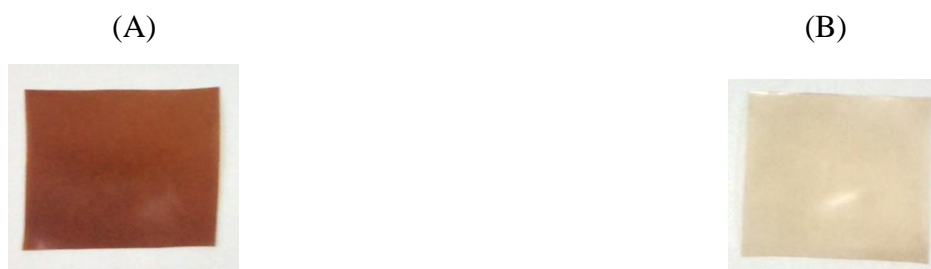
Figura 6. Filme biodegradável de farinha de arroz vermelho (A) e de amido de arroz vermelho (B).
