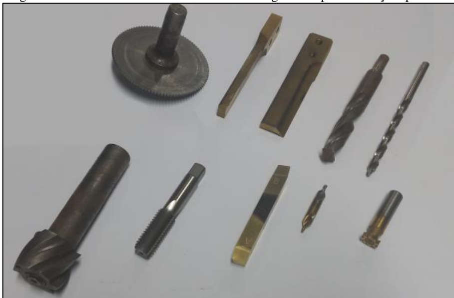
Figura 13 Diferentes ferramentas de corte e usinagem compostas de aço rápido.
