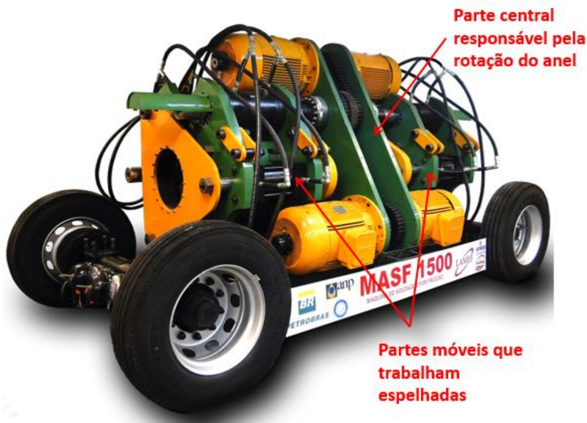
Figura 4-1 - Máquina de soldagem por fricção axial com anel rotativo desenvolvida e fabricada no LAMEF. Fonte: adaptado de (PISSANTI et al., 2015)
