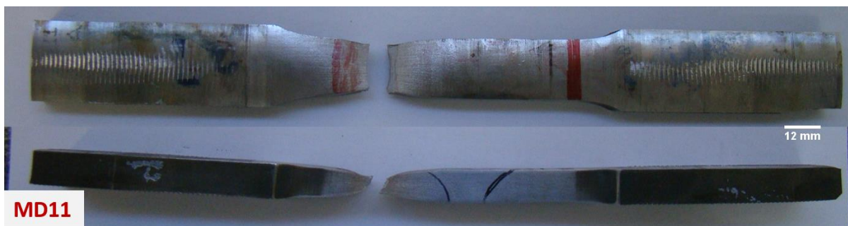
Figura 5-25 - Imagem representativa das condições de soldagem 4 (amostra da junta soldada MD11) indicando fratura no metal base.
