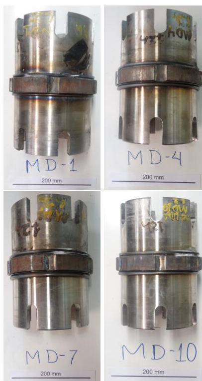
Figura 5-1 - Juntas soldadas produzidas com diferentes parâmetros de soldagem.
