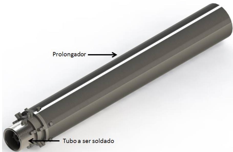
Figura 4-4 - Tubo a ser soldado e prolongador utilizado na MASF 1500.
