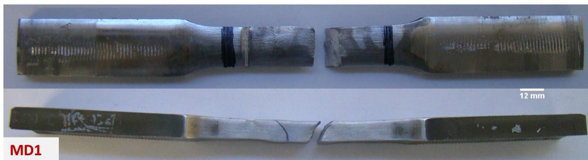
Figura 5-24 – Imagem representativa das condições de soldagem 1 (amostra da junta soldada MD1) indicando fratura na interface tubo-anel.
