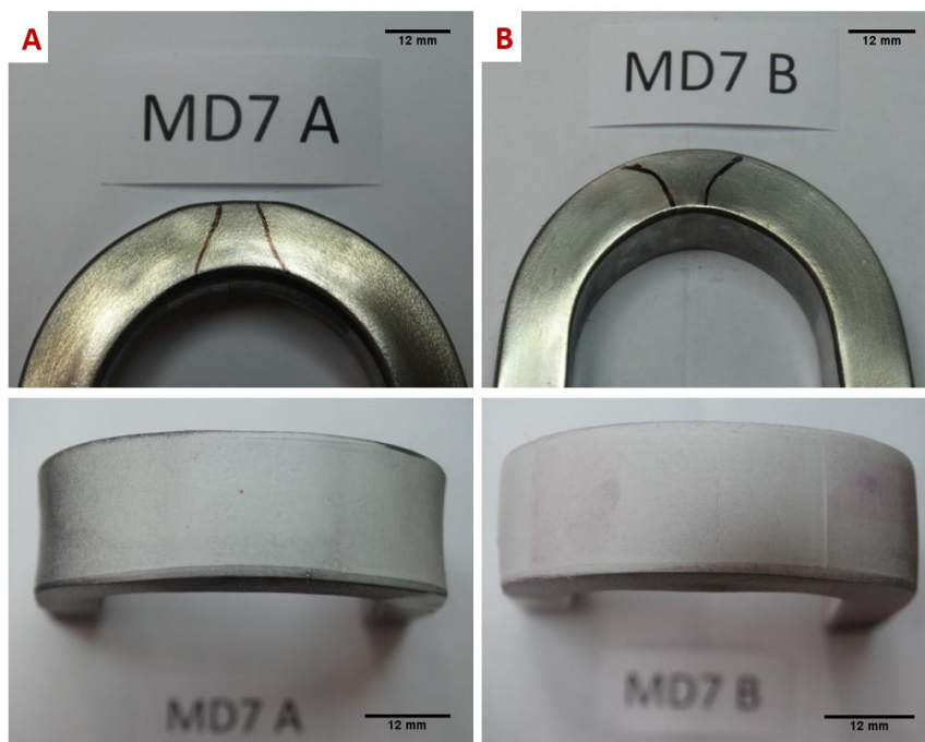
Figura 5-22 - Ensaio de dobramento realizados em amostras representativas da condição de soldagem 3 (MD7). A Imagem A mostra o ensaio de dobramento de raiz, enquanto a imagem B, o dobramento de face.
