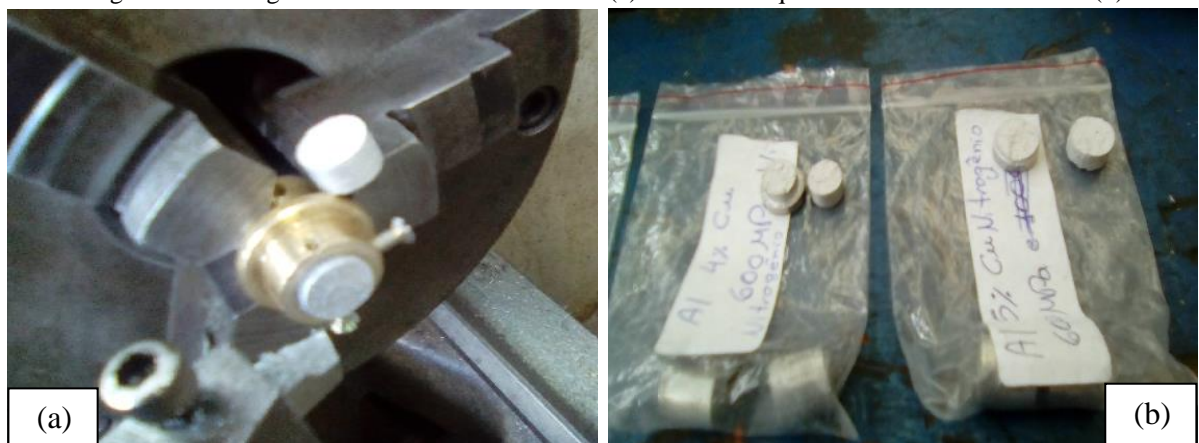
Figura 13: Usinagem da amostra com Al 1% Cu (a) e Amostras quebradas de Al 4% e 5% Cu (b)
