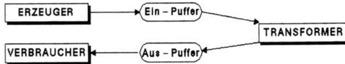
Bild 2.1.1 - Beispiel eines Systems mit drei unabhängigen Einheiten und zwei gemeinsamen Datenbeständen
