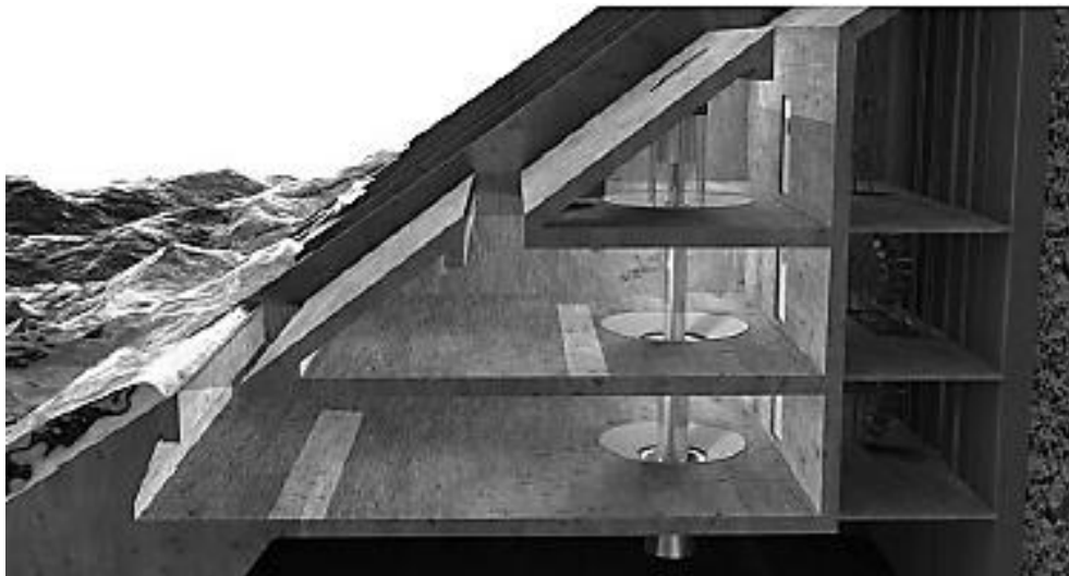
Figura 2.18 – Design do SSG (fonte: VICINANZA et al., 2012)
