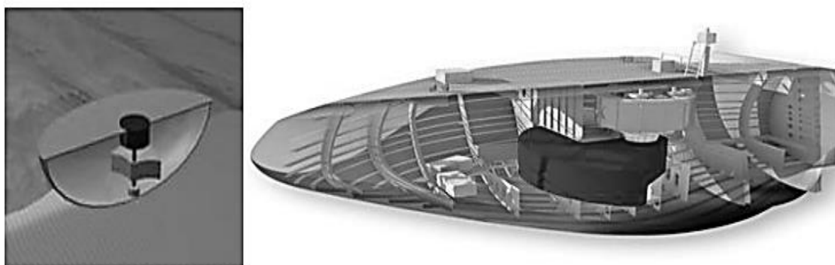
Figura 2.14 – Dispositivo conversor de rotação de massa ( Penguin ) (fonte: AMIR et al., 2016)
