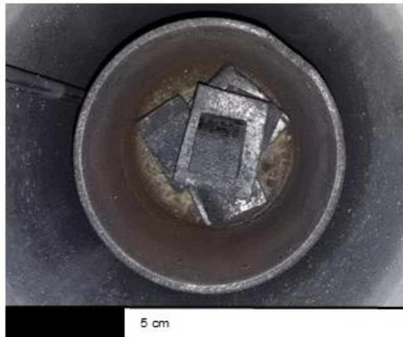
Figura 10. Teste de corrosão estática, amostras dentro do forno.
