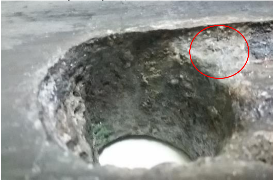
Figura 20 Região da placa com perda de carbono.
