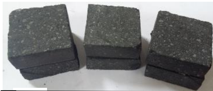
Figura 13. Três pares de placas de 1,5x4,5x4,5 mm com escória moída na parte central.
