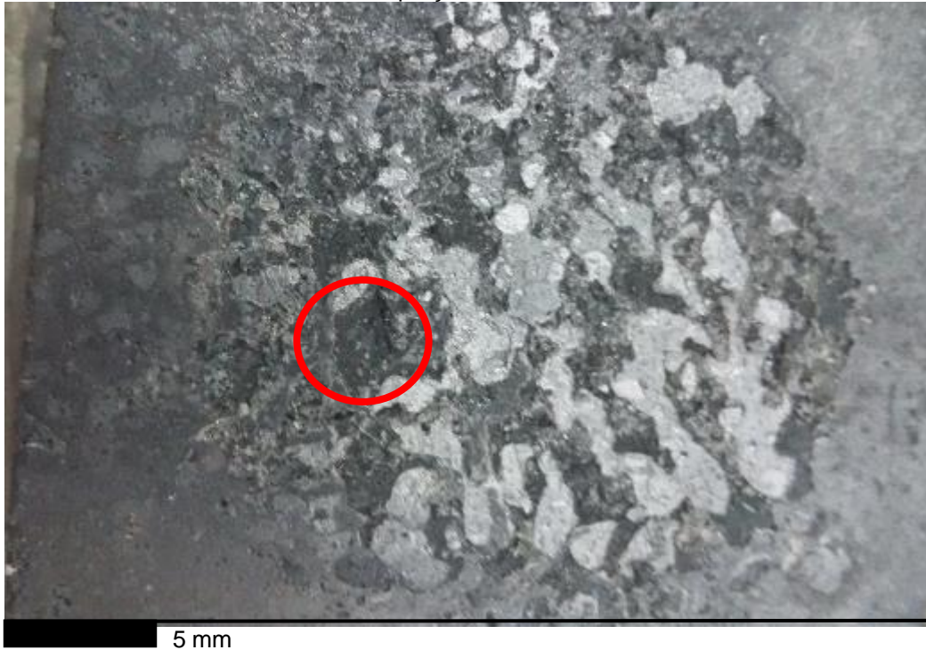
Figura 42. Corte do refratário \text{Al}_2\text{O}_3\text{-ZrO}_2\text{-C} após o ensaio de tração direta visualizado com Lupa indicando a porção de material extraída da amostra.
