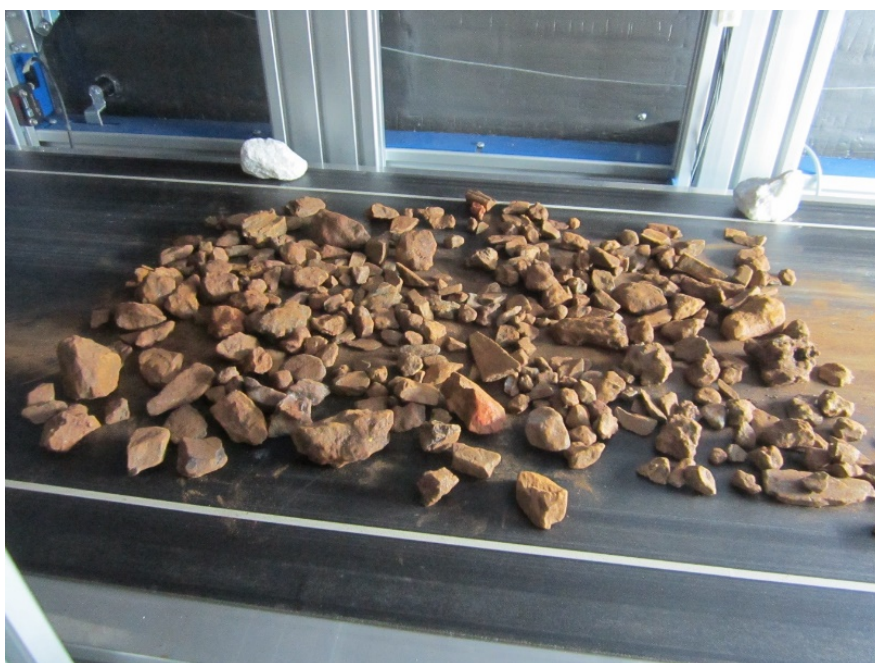
Figura 20. O minério de ferro na esteira antes de realizar o escaneamento .
