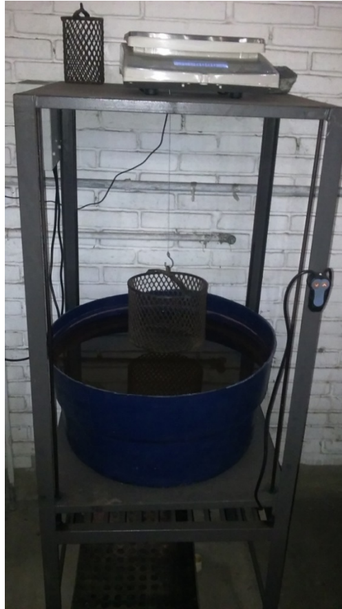
Figura 22. Balanço seguindo o Princípio Arquimedes
